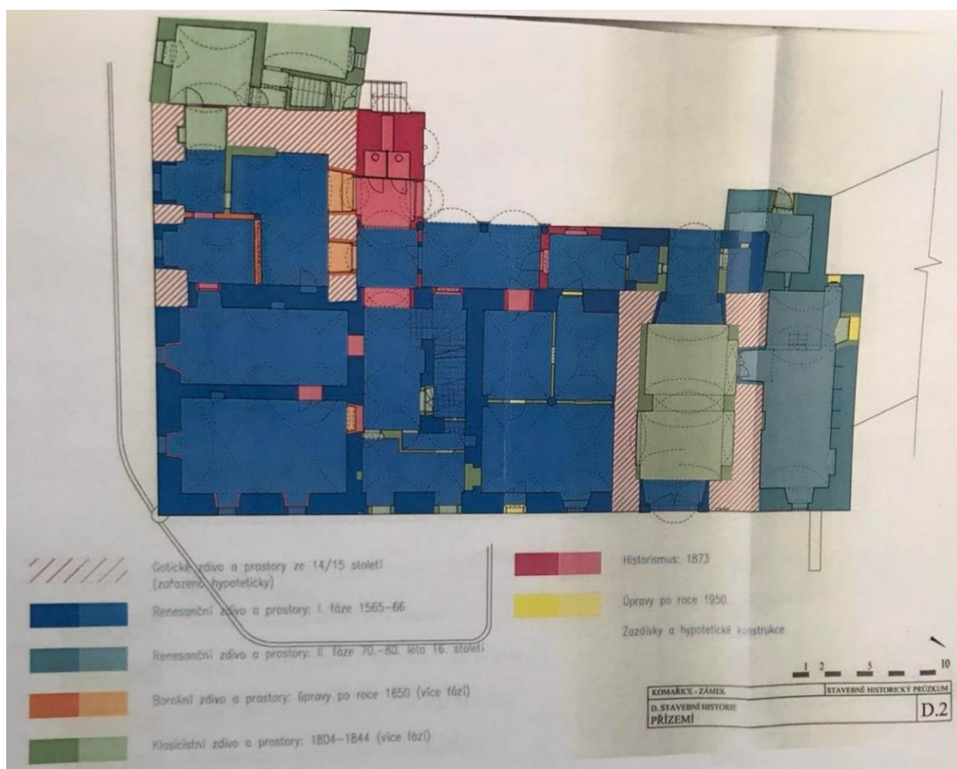
Obr. č. 5 Půdorys přízemí s barevným vyznačením částí stavby podle stavebních etap.
