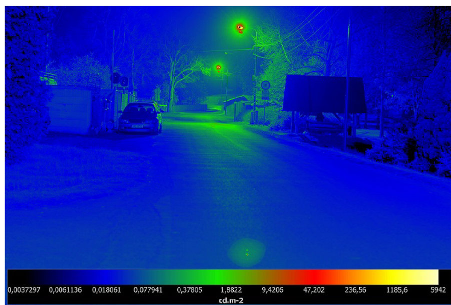
Obr. 4.6: Fotografia zobrazenia jasů na hlavnej ulici
