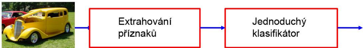
Obrázek 2.7: Schéma tradičního způsobu klasifikace obrazu [16]
