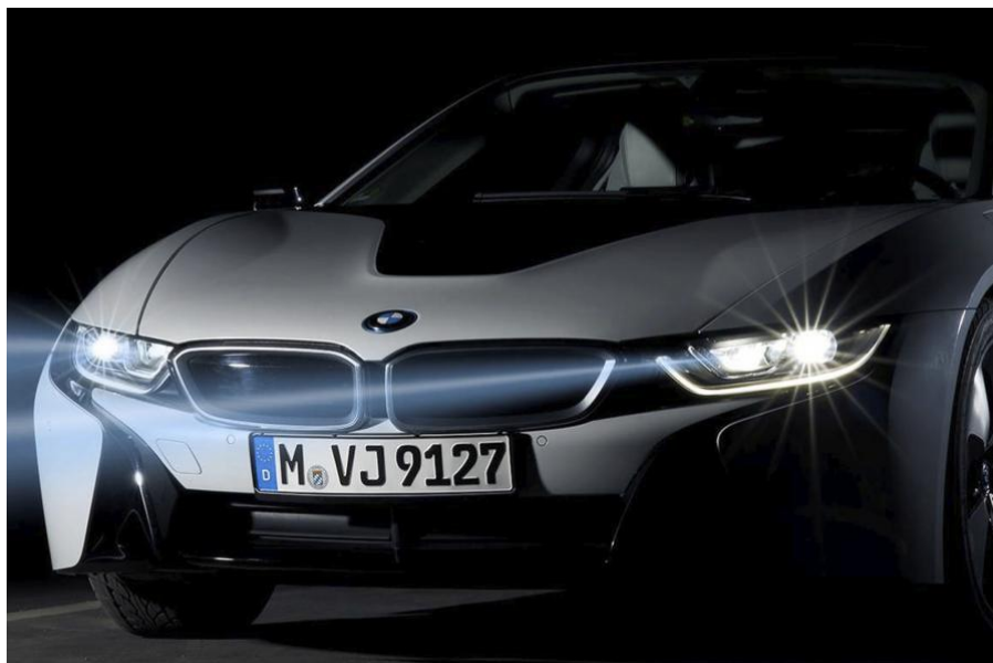
Obr. 6: BMW i8 s laserovými světlomety [9]
