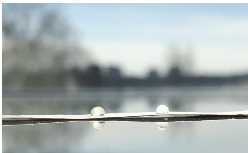
Obrázek 13: Kapky na povrchu nanovláken, vzorek 3:1 s čistým MeOH
