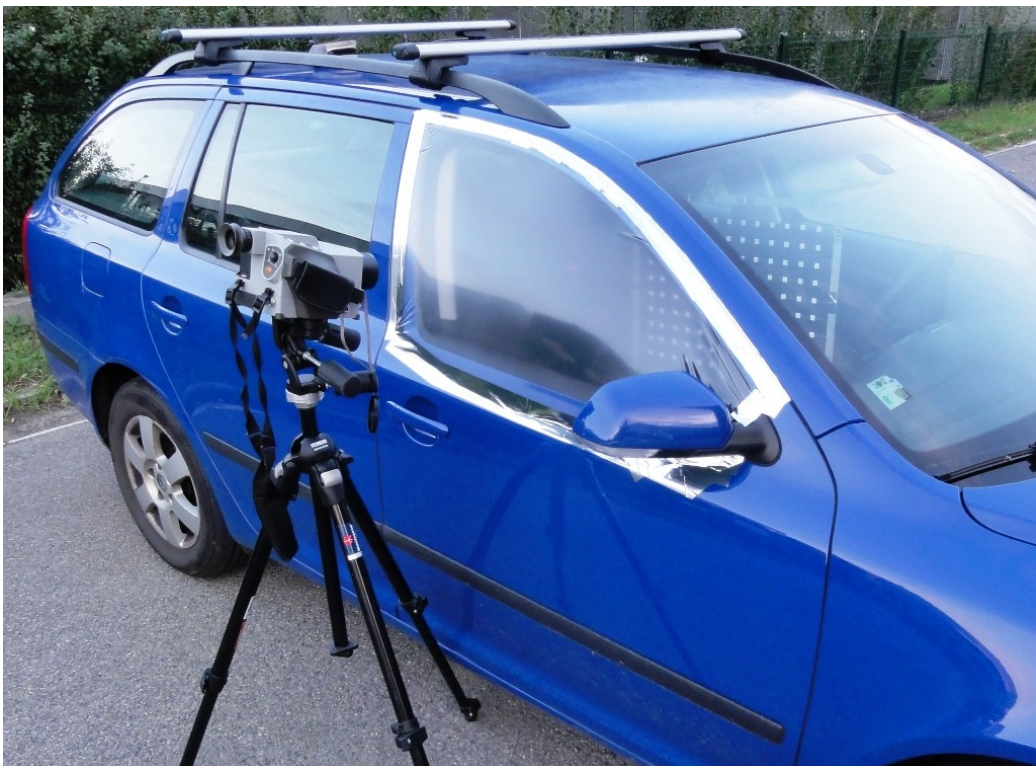
Obr. 8.6 Fotografie zařízení pro termovizní měření teplotních polí ve vzduchu v kabině automobilu skrz průzor
