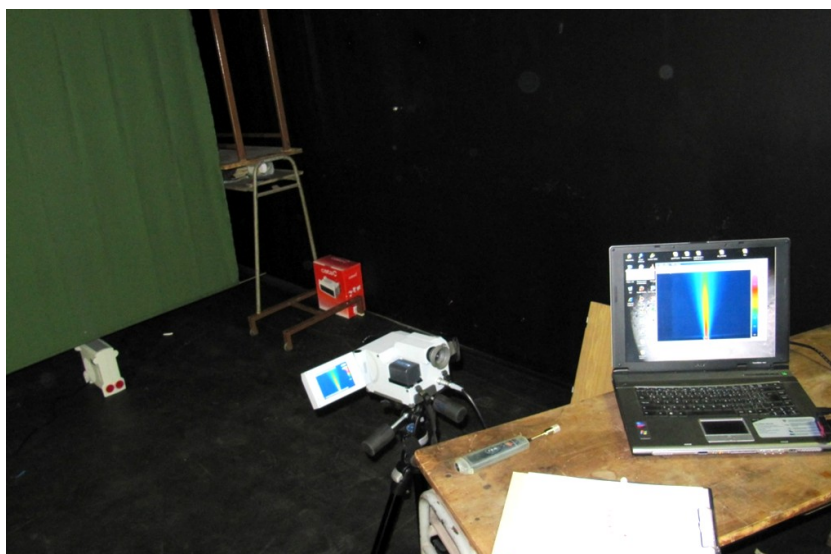
Obr. 5.7 Fotografie zařízení pro měření časové konstanty
