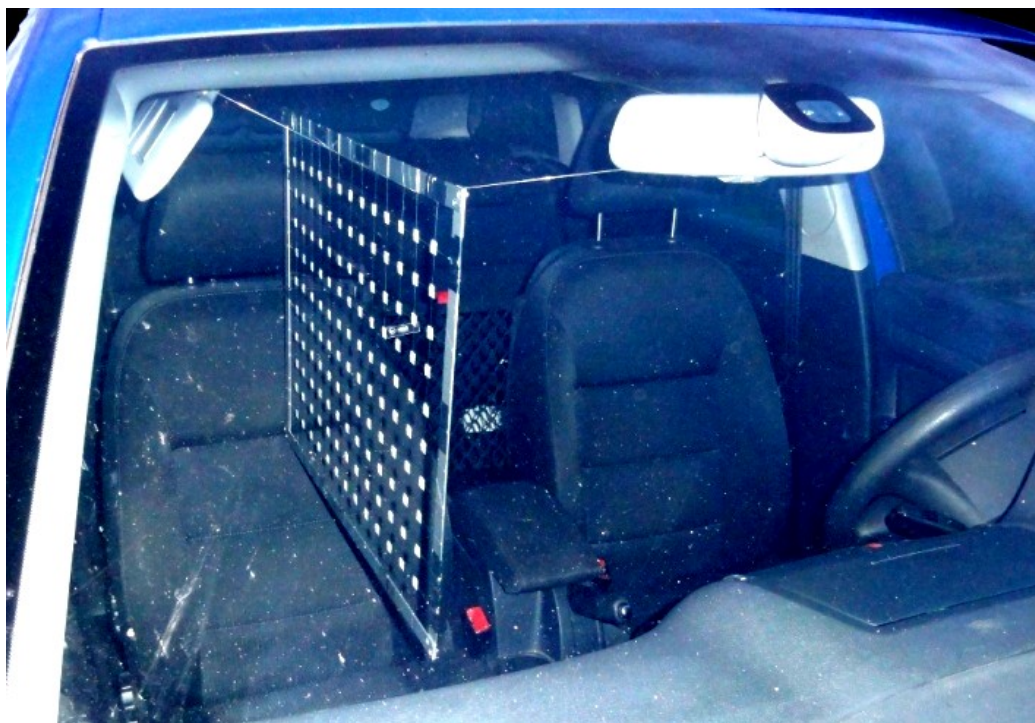
Obr. 8.7 Umístění měřicí sítě pro měření 3D neizotermních vzduchových proudů v kabině automobilu na předním sedadle spolujezdce
