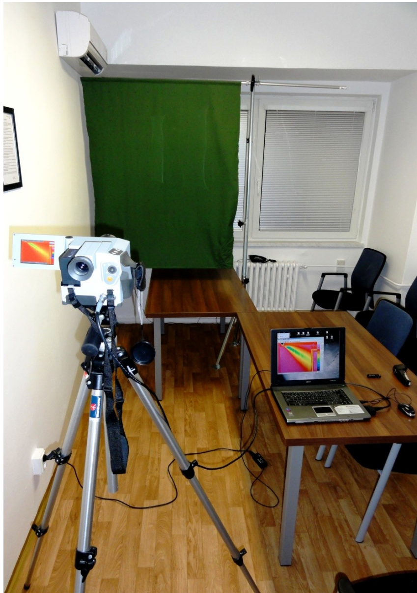
Obr. 8.2 Fotografie sestavy pro měření 2D teplotních polí ve vzduchu pomocí termovizní kamery od vzduchotechnické vyústky v kancelářských prostorech
