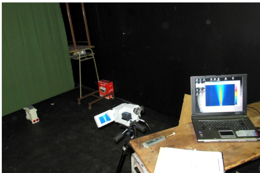
Obr. 5.7 Fotografie zařízení pro měření časové konstanty
