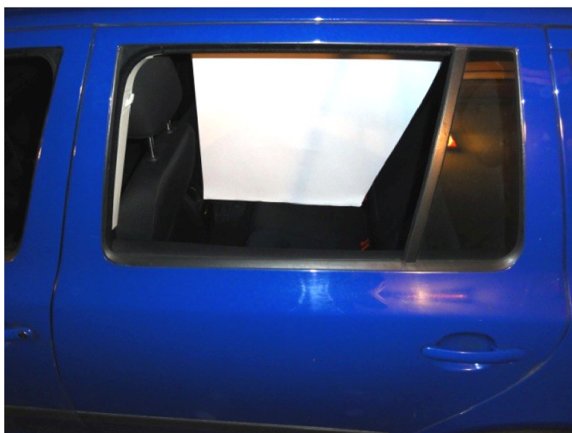
Obr. 6.8 Fotografie umístění celistvého pomocného materiálu při měření 2D neizotermního vzduchového proudu
