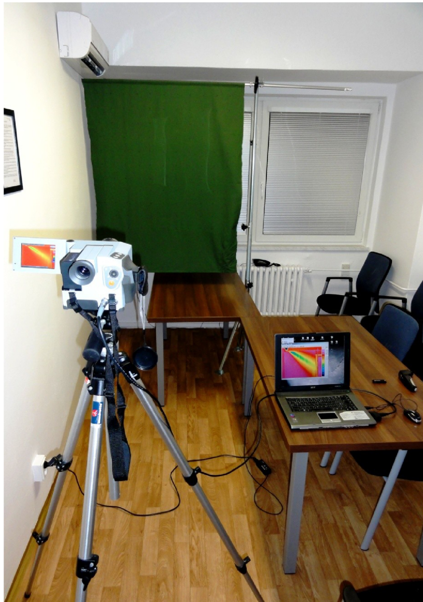
Obr. 8.2 Fotografie sestavy pro měření 2D teplotních polí ve vzduchu pomocí termovizní kamery od vzduchotechnické výústky v kancelářských prostorech
