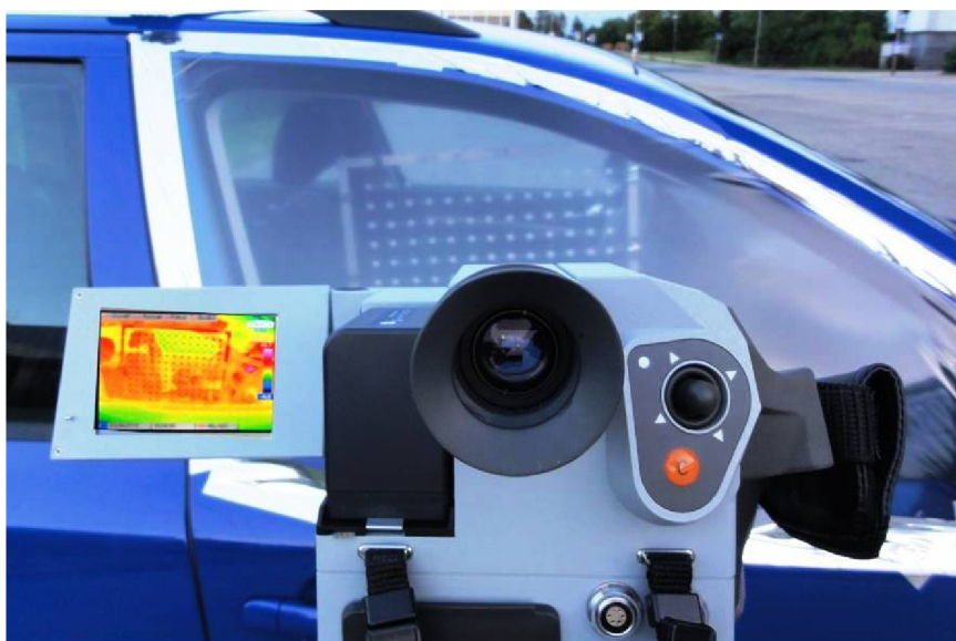
Obr. 6.7 Fotografie zařízení pro termovizní měření teplotních polí ve vzduchu v kabině automobilu skrz průzor
