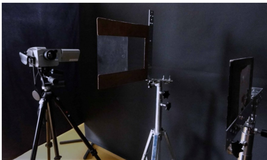
Obr. 5.12 Fotografie zařízení pro měření transmittance fólie
