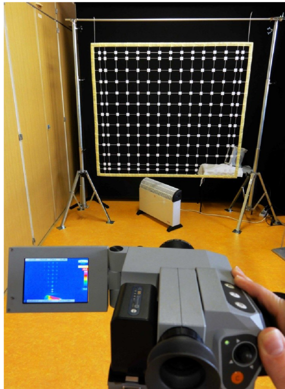
Obr. 5.2 Fotografie zařízení pro měření teplotních polí ve 3D proudu vzduchu pomocí termovizní kamery a měřících terčů
