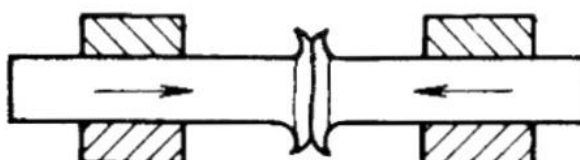
Obr. 11 Stykové odtavovací svařování [15]
