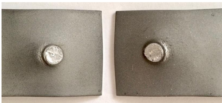
Obr. 26 Porušení základního materiálu v místě tepelně ovlivněné oblasti
