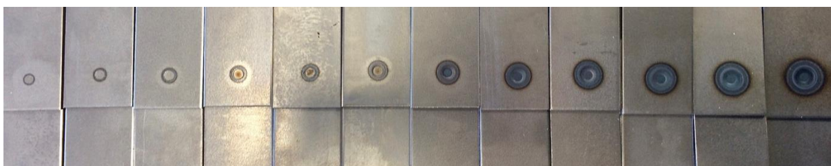
Obr. 23 Velikost tepelně ovlivněné oblasti v závislosti na svařovacím čase
