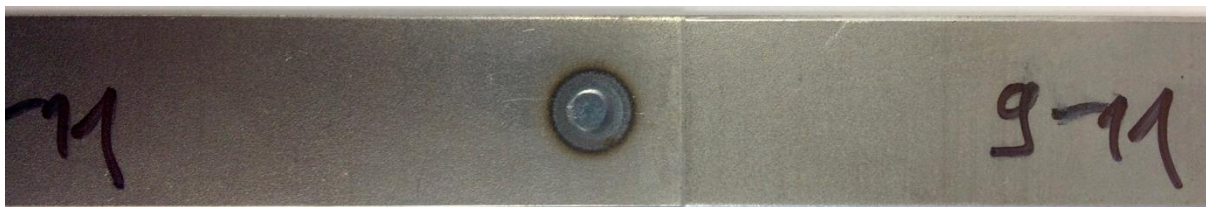
Obr. 22 Vzorek svarového spoje
