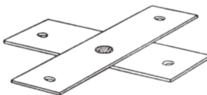
Obr. 14 Tvar zkoušené součásti při U-zkoušce [17]
