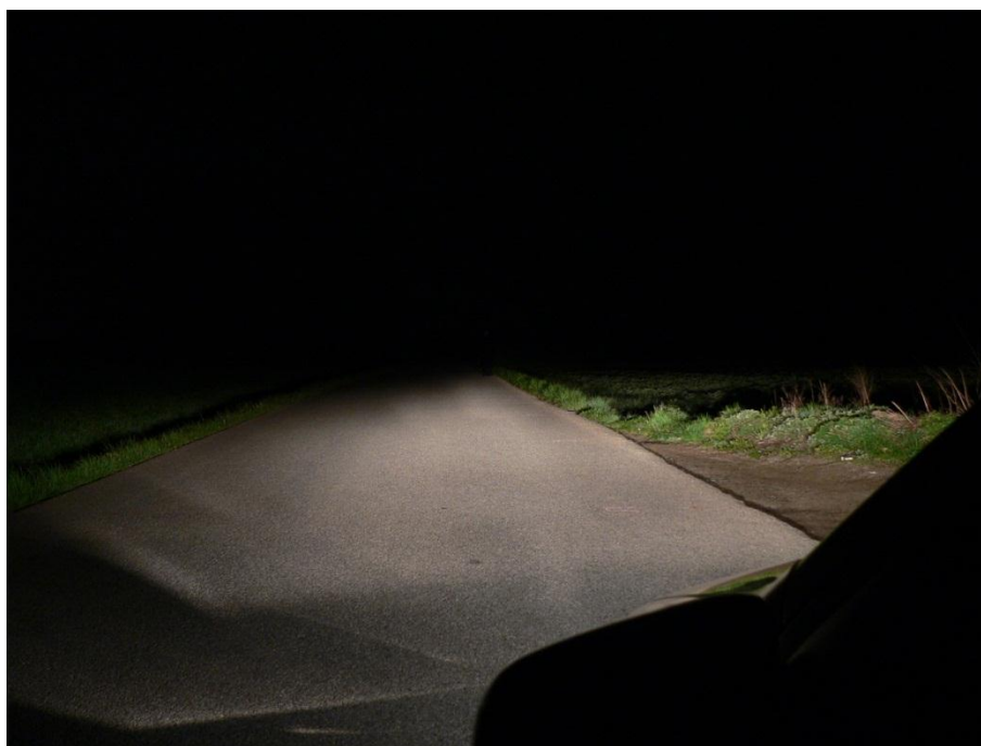
Obr. č. 4 – 58 Figurant v černém oblečení ve vzdálenosti 36,5 m před vozidlem Škoda Fabia při zapnutých potkávacích světlech
