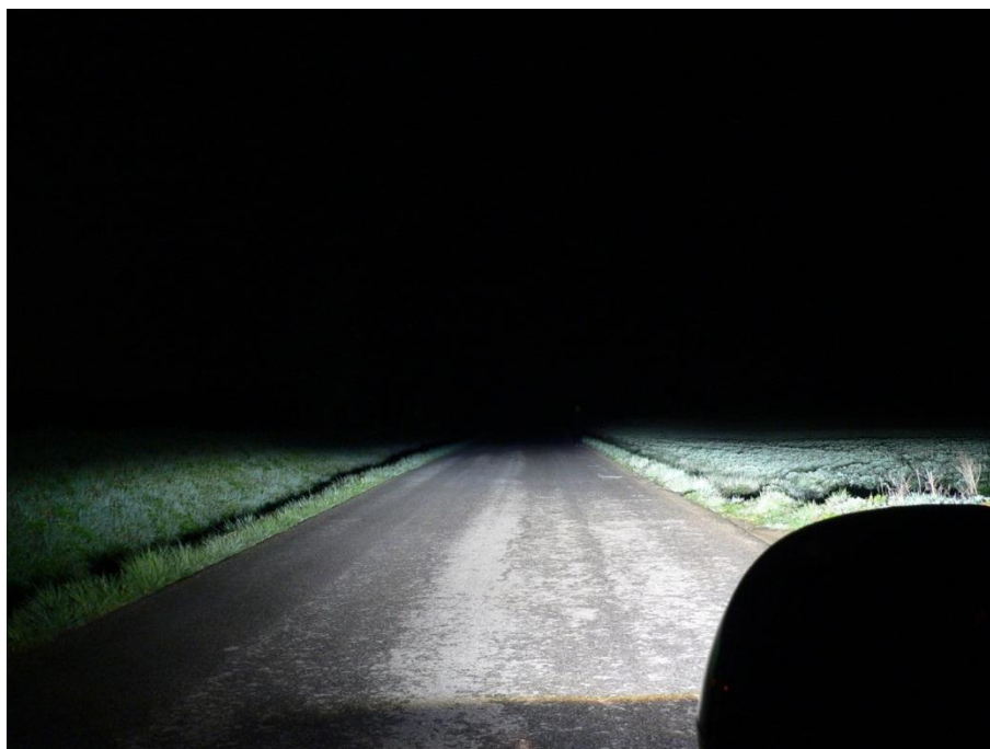
Obr. č. 4 – 52 Figurant v běžném oblečení ve vzdálenosti 41 m před vozidlem Audi Q7 při zapnutých tlumených světlech
