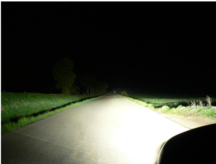
Obr. č. 4 – 29 Figurant bílý ve vzdálenosti 200 m před vozidlem Audi A4 při zapnutých dálkových světlech
