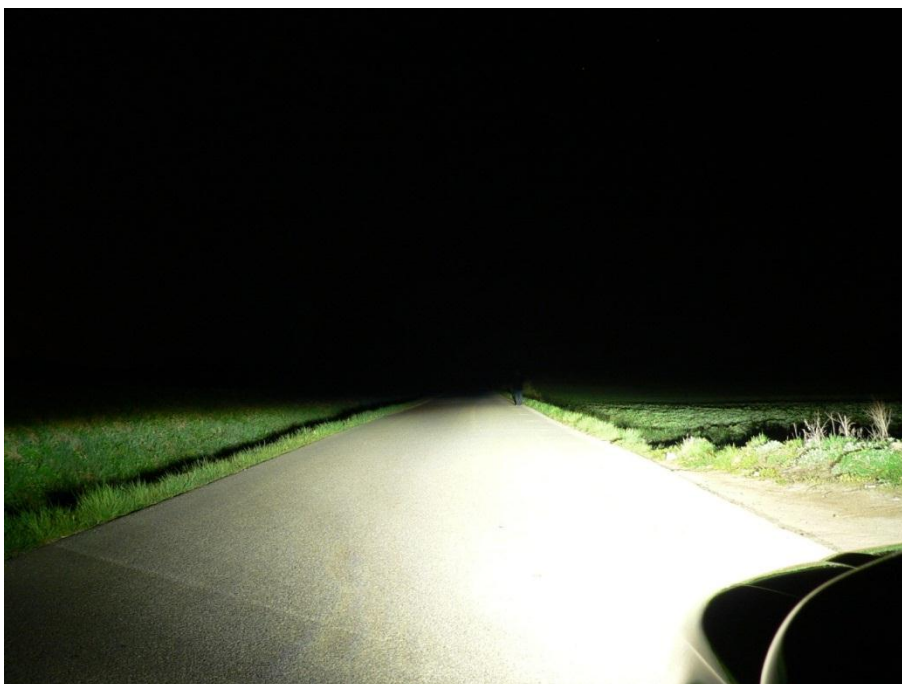
Obr. č. 4 – 50 Figurant v běžném oblečení ve vzdálenosti 48 m před vozidlem Audi A4 při zapnutých tlumených světlech
