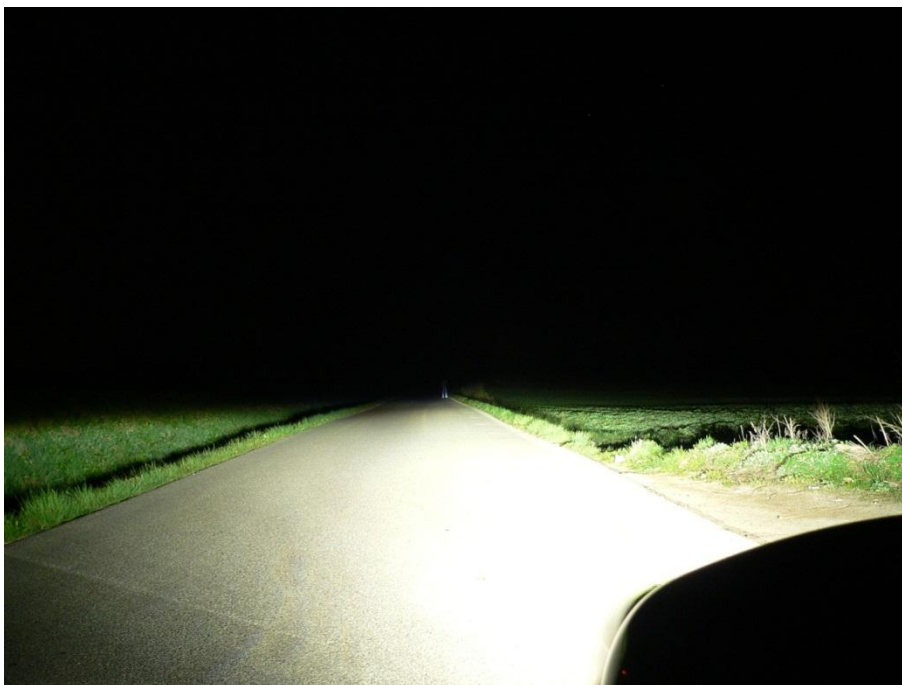
Obr. č. 4 – 48 Figurant v bílém oblečení ve vzdálenosti 80 m před vozidlem Audi A4 při zapnutých tlumených světlech
