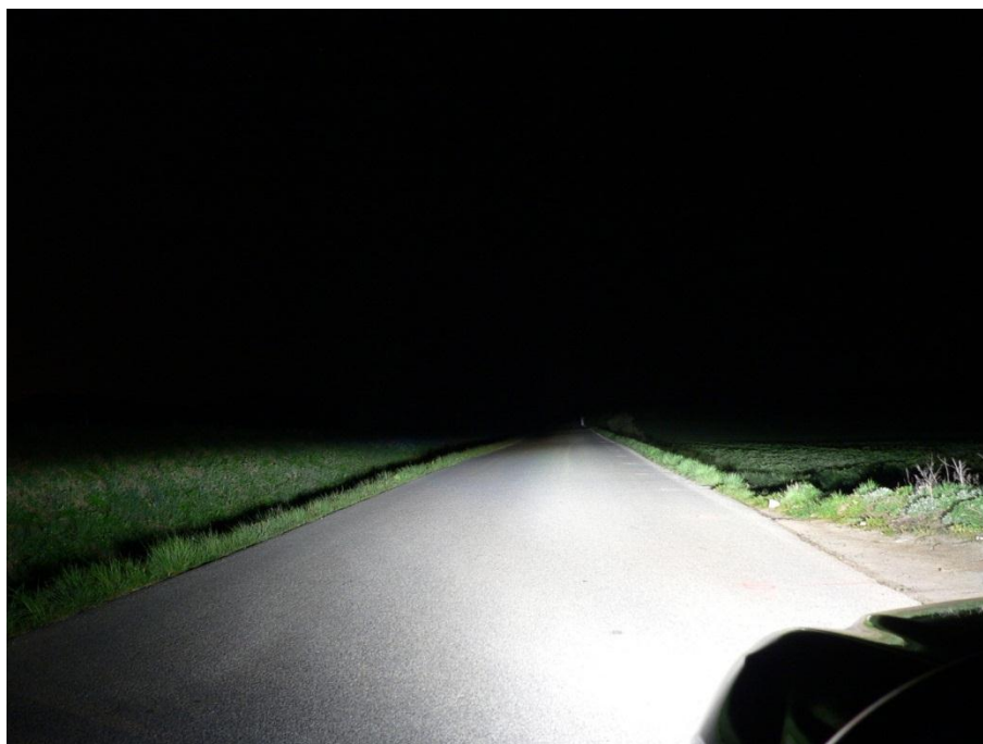
Obr. č. 4 – 44 Figurant v bílém oblečení ve vzdálenosti 150 m před vozidlem Mercedes-Benz S500 při zapnutých tlumených světlech
