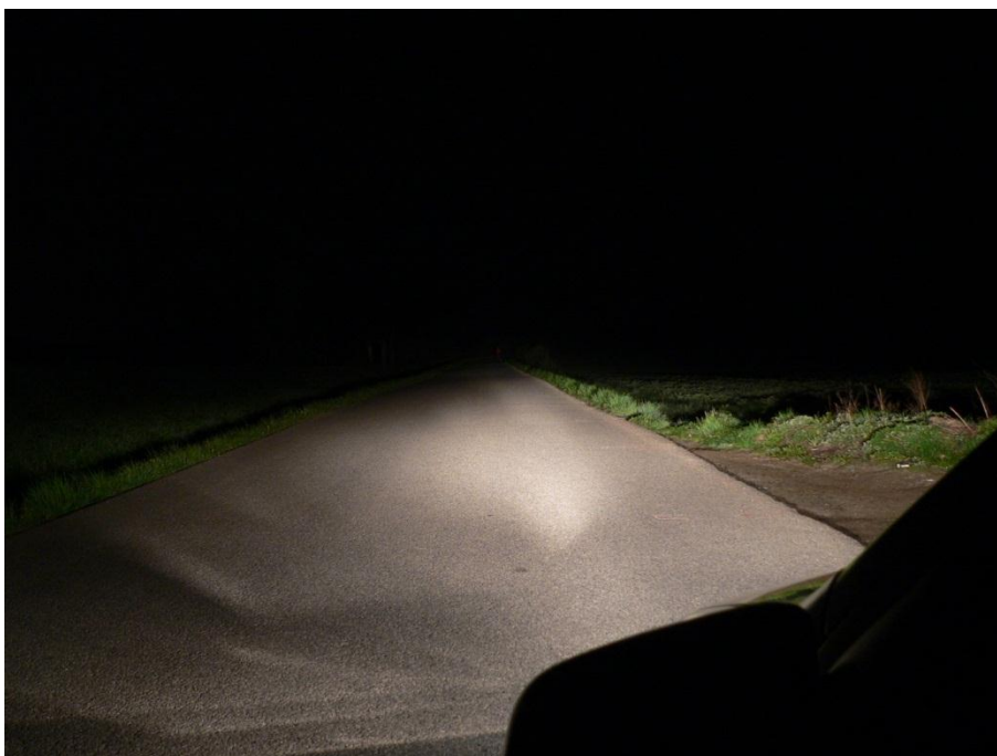
Obr. č. 4 – 42 Figurant v běžném oblečení ve vzdálenosti 147 m před vozidlem Škoda Fabia při zapnutých dálkových světlech
