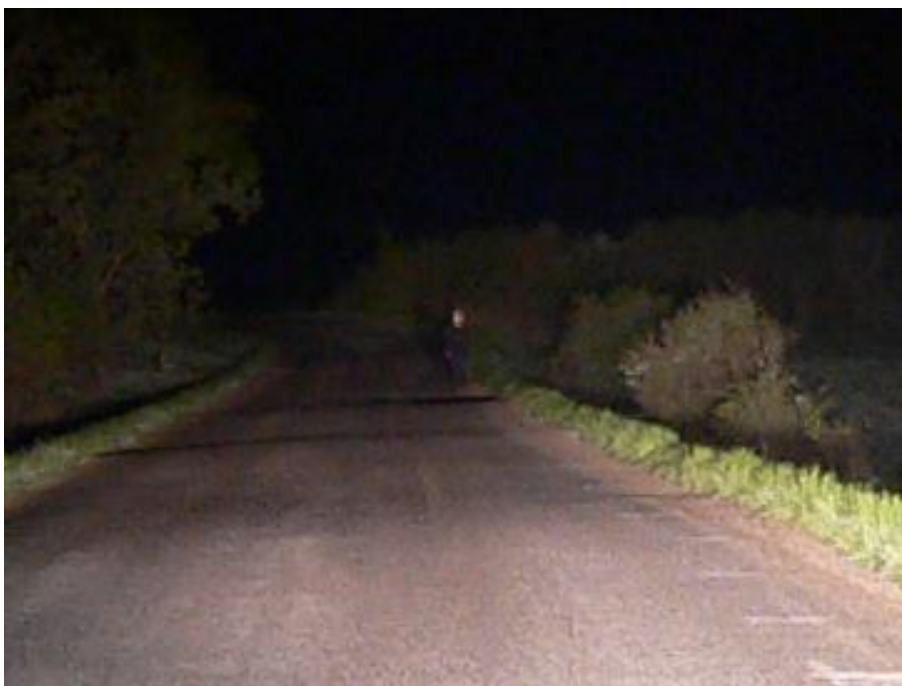
Obr. č. 4 – 33 Detail figuranta v černém oblečení ve vzdálenosti 145 m před vozidlem Mercedes-Benz S500 při zapnutých dálkových světlech
