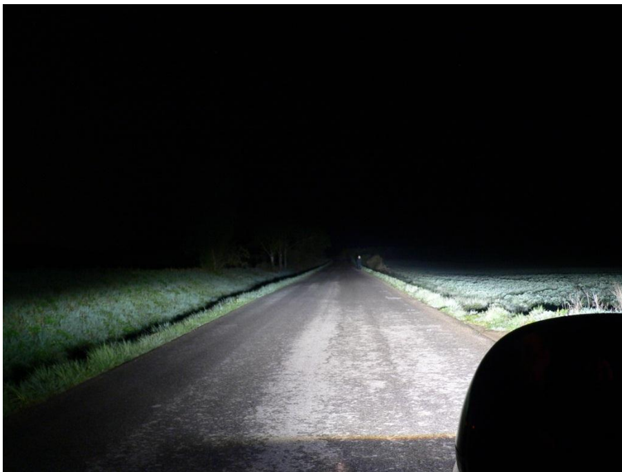
Obr. č. 4 – 38 Figurant černý ve vzdálenosti 77 m před vozidlem Audi Q7 při zapnutých dálkových světlech
