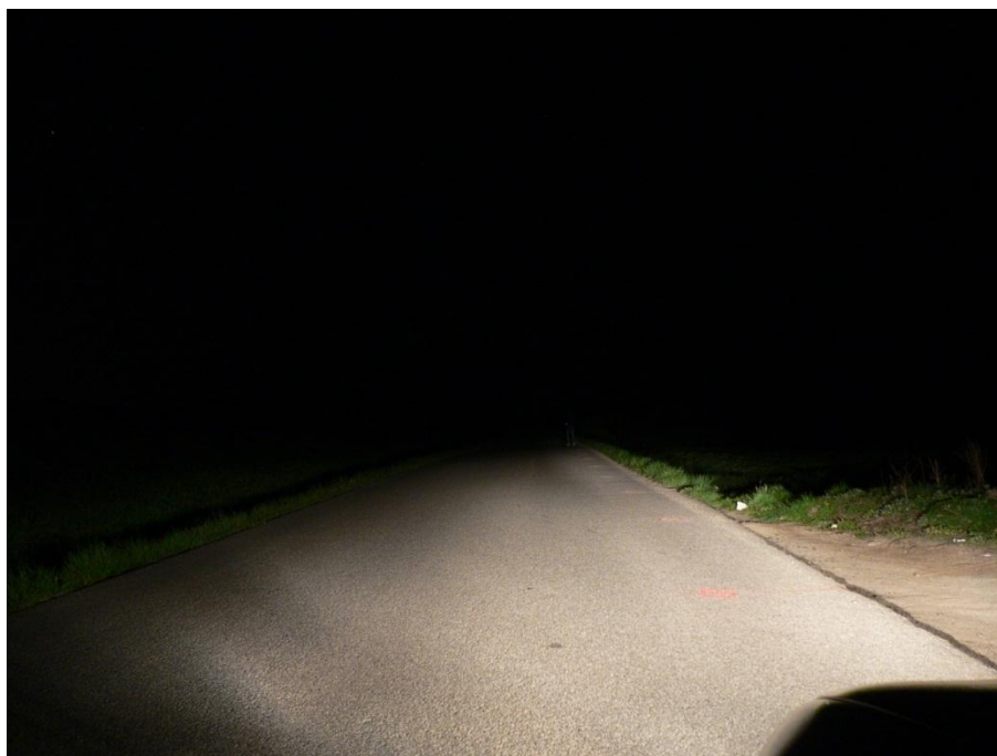
Obr. č. 4 – 57 Figurant v běžném oblečení ve vzdálenosti 51 m před vozidlem Opel Corsa při zapnutých tlumených světlech
