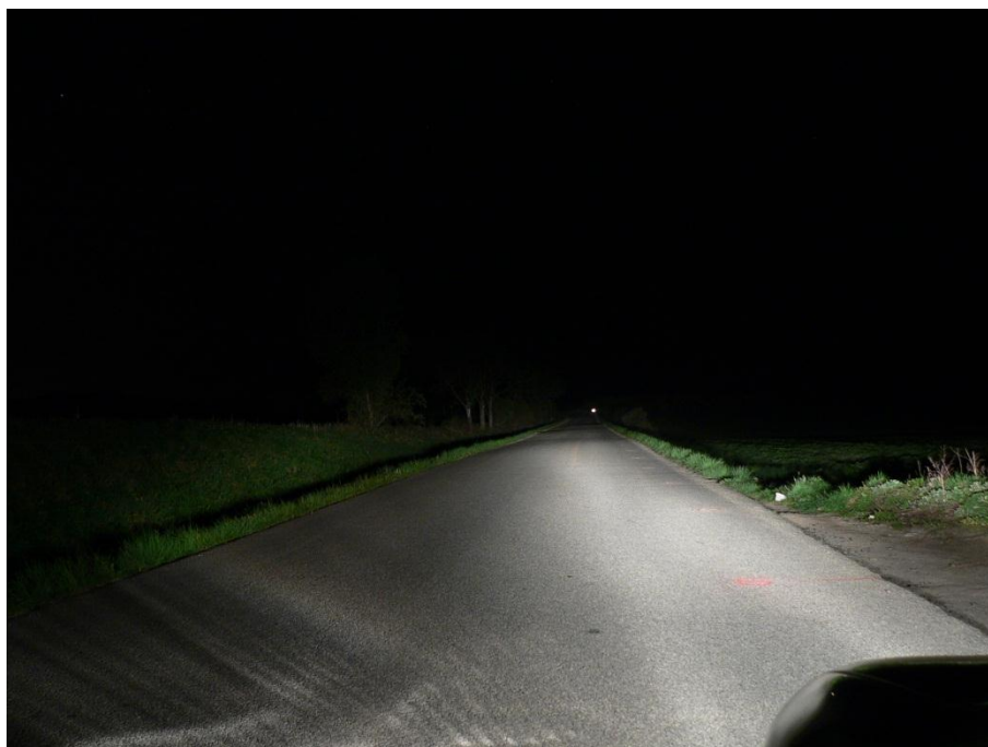
Obr. č. 4 – 26 Figurant v reflexní vestě ve vzdálenosti 200 m před vozidlem Opel Corsa při zapnutých dálkových světlech
