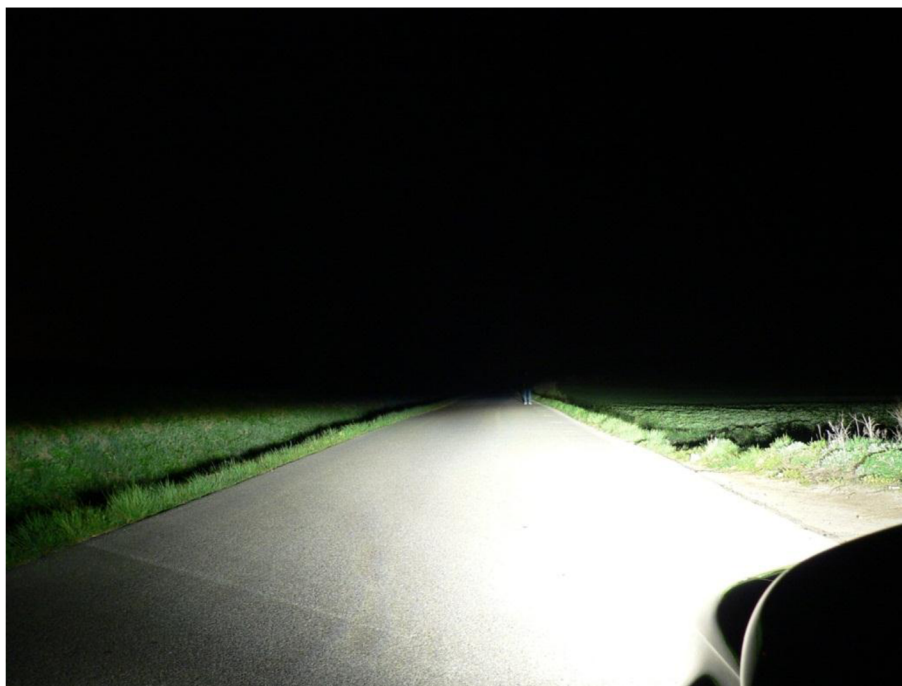
Obr. č. 4 – 49 Figurant v černém oblečení ve vzdálenosti 40,5 m před vozidlem Audi A4 při zapnutých tlumených světlech
