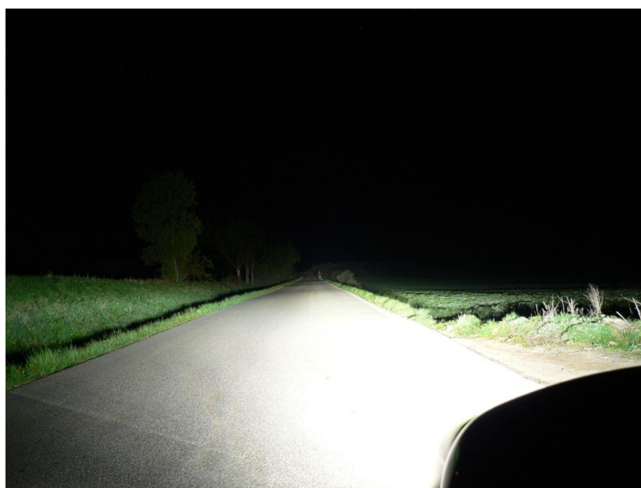
Obr. č. 4 – 37 Figurant v běžném oblečení ve vzdálenosti 126 m před vozidlem Audi A4 při zapnutých dálkových světlech
