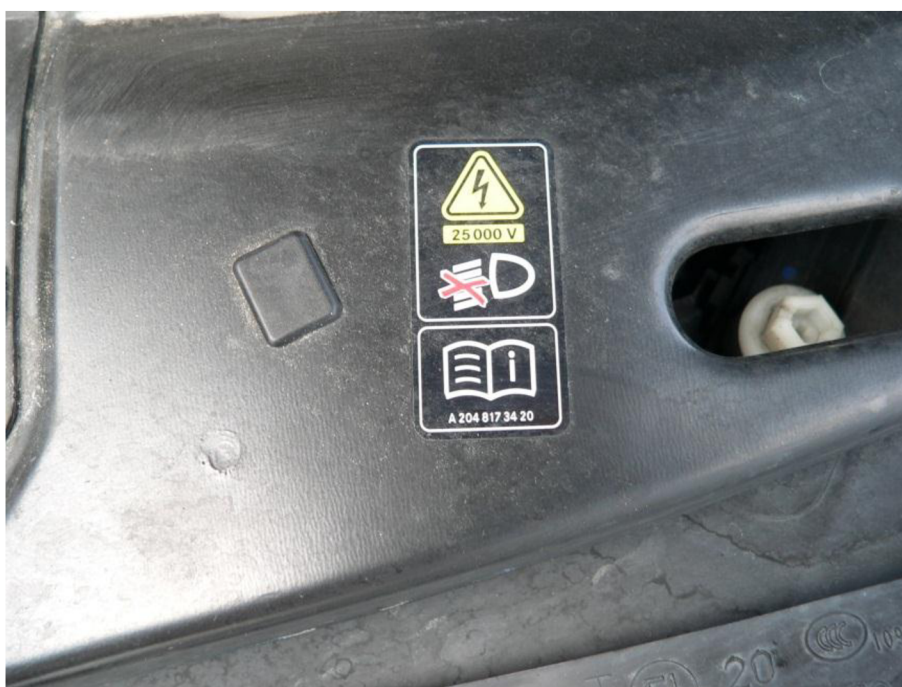
Obr. č. 4 – 25 Symbol sklonu světlometu u vozidla Mercedes-Benz S500
