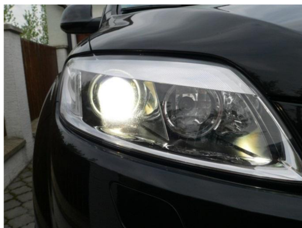
Světlomet vozidla Audi Q7, vlevo thumené a vpravo dálkově světlo
