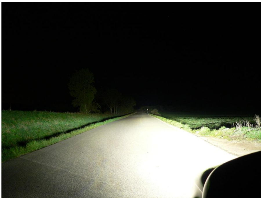
Obr. č. 4 – 36 Figurant černý ve vzdálenosti 80,5 m před vozidlem Audi A4 při zapnutých dálkových světlech
