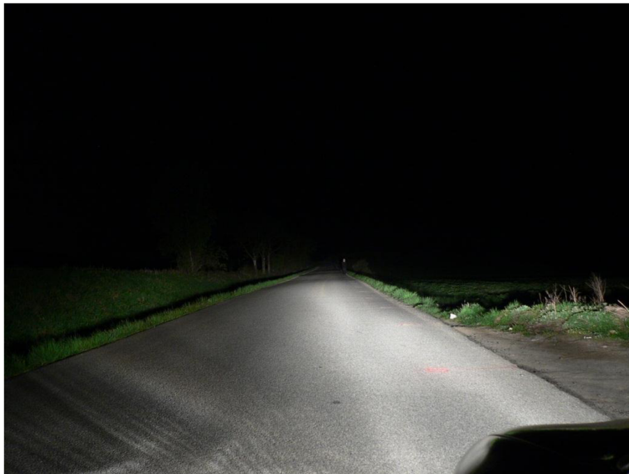
Obr. č. 4 – 31 Figurant černý ve vzdálenosti 69 m před vozidlem Opel Corsa při zapnutých dálkových světlech
