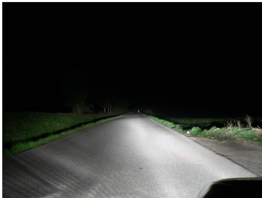
Obr. č. 4 – 28 Figurant bílý ve vzdálenosti 139 m před vozidlem Opel Corsa při zapnutých dálkových světlech
