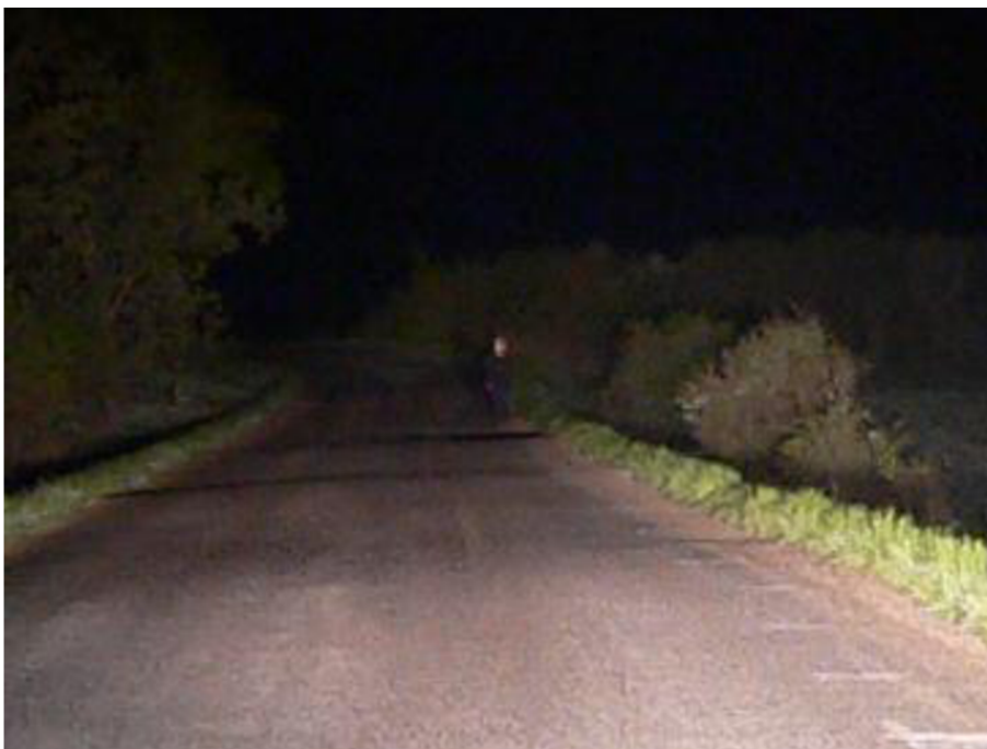
Obr. č. 4 – 33 Detail figuranta v černém oblečení ve vzdálenosti 145 m před vozidlem Mercedes-Benz S500 při zapnutých dálkových světlech
