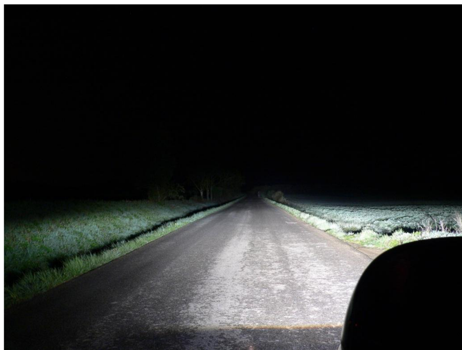
Obr. č. 4 – 39 Figurant v běžném oblečení ve vzdálenosti 142 m před vozidlem Audi Q7 při zapnutých dálkových světlech
