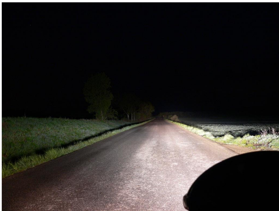
Obr. č. 4 – 32 Figurant černý ve vzdálenosti 145 m před vozidlem Mercedes-Benz S500 při zapnutých dálkových světlech
