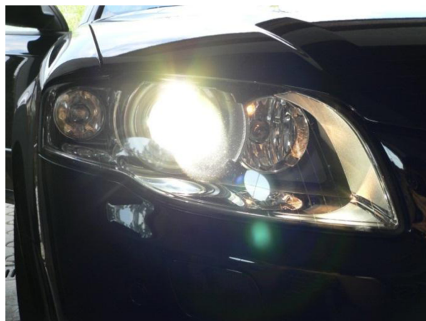
Světlomet vozidla Audi A4, vlevo thumené a vpravo dálkově světlo
