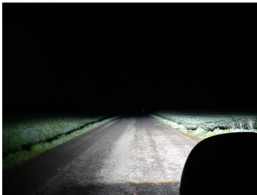
Obr. č. 4 – 51 Figurant v bílém oblečení ve vzdálenosti 77 m před vozidlem Audi Q7 při zapnutých tlumených světlech
