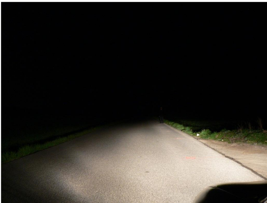
Obr. č. 4 – 56 Figurant v černém oblečení ve vzdálenosti 26,8 m před vozidlem Opel Corsa při zapnutých tlumených světlech
