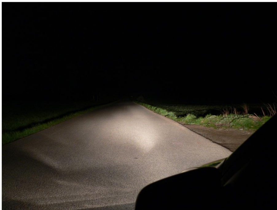
Obr. č. 4 – 34 Figurant černý ve vzdálenosti 90 m před vozidlem Škoda Fabia při zapnutých dálkových světlech
