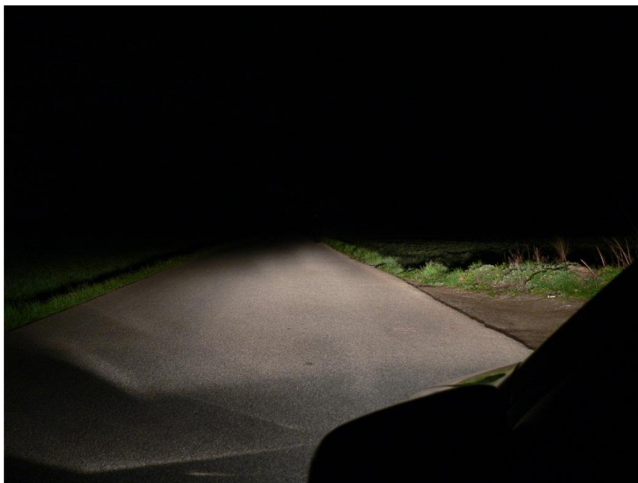
Obr. č. 4 – 58 Figurant v černém oblečení ve vzdálenosti 36,5 m před vozidlem Škoda Fabia při zapnutých potkávacích světlech
