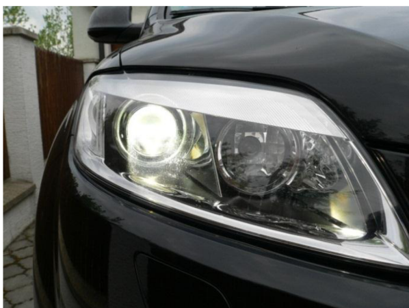
Světlomet vozidla Audi Q7, vlevo thumené a vpravo dálkově světlo
