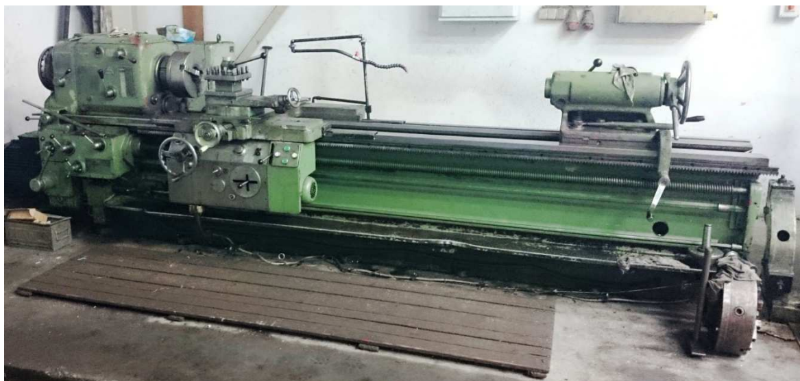
Obr. 3.1 Universální hrotový soustruh TOS Čelákovice SU63 A/2750.
