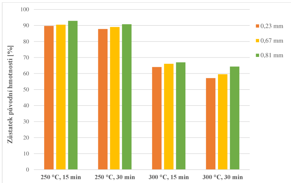
Obrázek 19: Vliv velikosti částic pilin z borovice na změnu hmotnosti při torefakci [55, 64].
