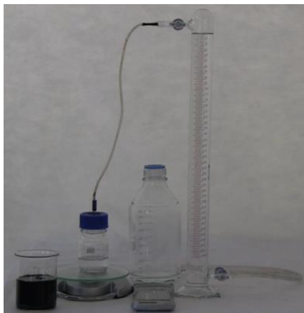
Obrázek 4.3 Aparatura pro měření. Odměrný válec o objemu 400 ml je naplněn vodou a spojen hadičkou s nádobkou, ve které je reagující roztok železa s hydrogensíranem sodným. Při reakci tak klesá hladina vody v odměrném válci, která je vytlačena příslušným objemem vodíku (Nanoiron 2019)
