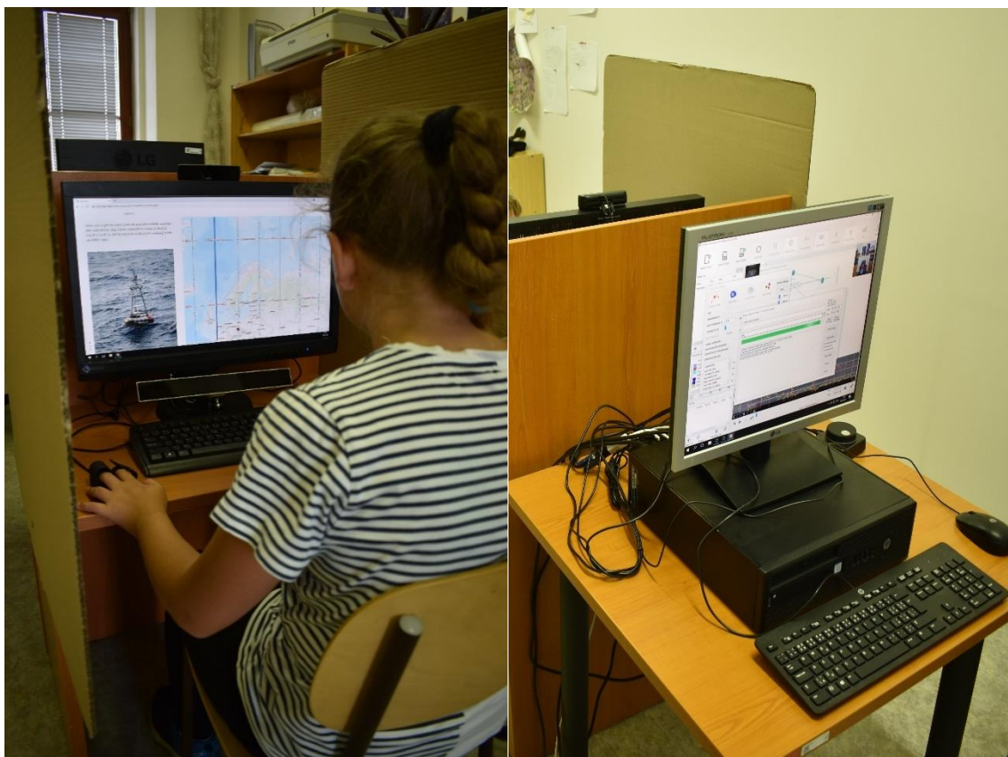
Obrázek 9: Gazeport testovací sestava. (Vlevo) Na horní hraně monitoru je webkamera zaznamenávající celkový pohled na žáka, pod monitorem je umístěn 3GP eye-tracker a žák má na levé ruce připevněn biometrický kit. (Vpravo) Naproti přes přepážku je umístěn počítač a monitor operátora.
