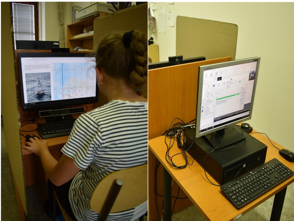
Obrázek 9: Gazepoint testovací sestava. (Vlevo) Na horní hraně monitoru je webkamera zaznamenávající celkový pohled na žáka, pod monitorem je umístěn 3GP eye-tracker a žák má na levé ruce připevněn biometrický kit. (Vpravo) Naproti přes přepážku je umístěn počítač a monitor operátora.
