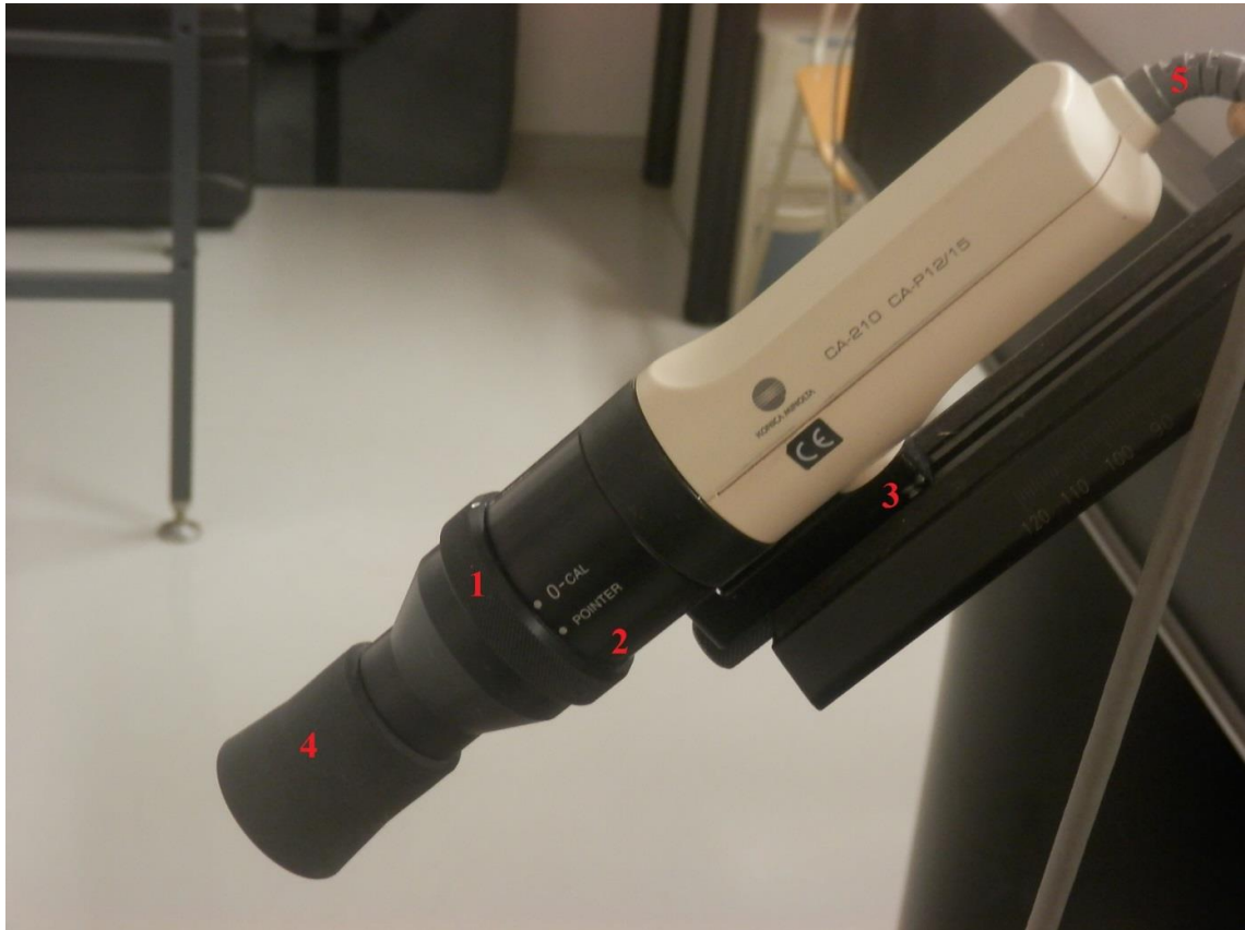
Obr. 10 Sonda CA-PU12 s doplněným popisem. 1 - polohovací kroužek, 2 - zarážka, 3 - otvor pro uchycení šroubu ke stativu, 4 - standardní clona proti vstupu světla, 5 - propojovací konektor
