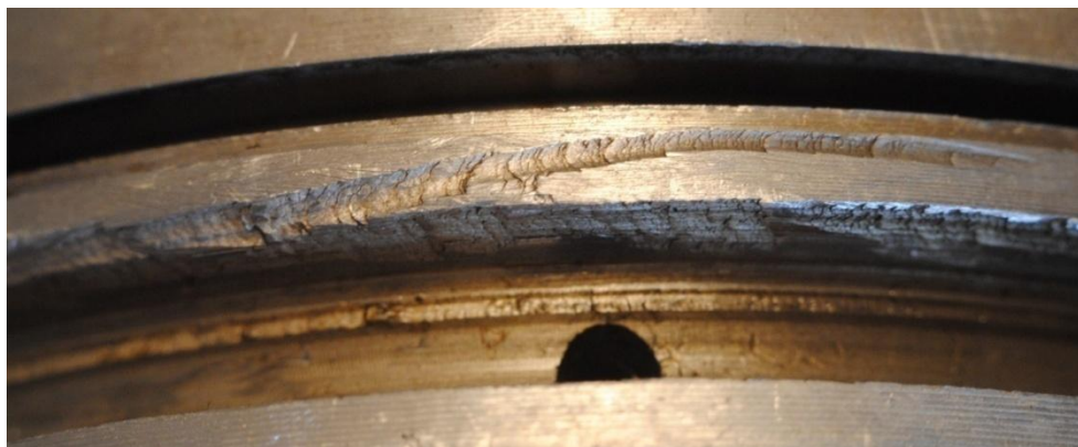
Obr. 14 Poškození pístu od nástroje
