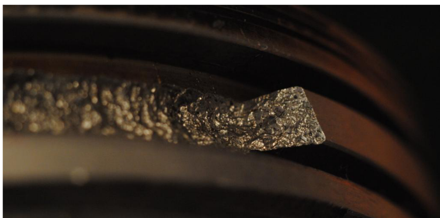
Obr. 8 Druhý můstek v místě poškození
