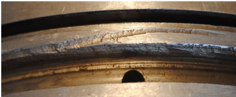
Obr. 14 Poškození pístu od nástroje
