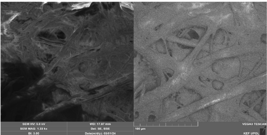
Obr. 42: SEM snímek substrátu CEL100, BSE snímek vpravo, měřítko 100 μm
