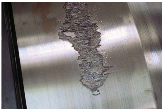
Obr. 1.2: Poškozený vnitřní kroužek (podpovrchová únava) [3]
