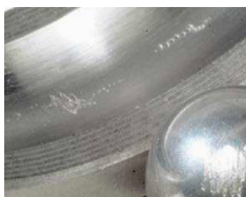
Obr. 1.5: Kroužek a valivý element poškozený erozí el. proudem [3]
