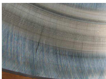
(a) Abrasivní poškození - vnitřní kroužek
