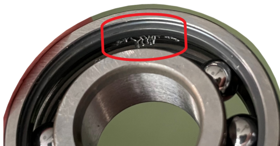
Obr. 4.3: Poškození vnější dráhy druhého ložiska
