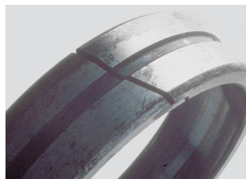
(b) Únavová prasklina na vnějším kroužku
