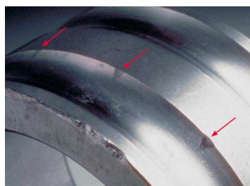
(a) Promáčklina v dráze ložiska
