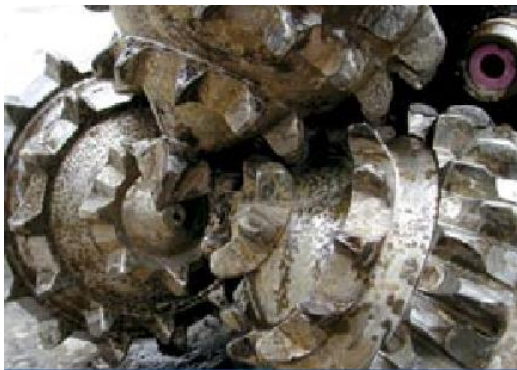
Obrázok 22 – valivé vrtné dláto (vľavo) [8] a ťažobný kozlík (vpravo) [13]
