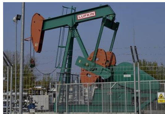
Obrázok 22 – valivé vrtné dláto (vľavo) [8] a ťažobný kozlík (vpravo) [13]
