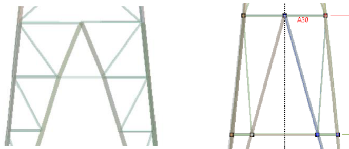
Obrázok 48 – pohľad na poschodie, v ktorom sa spájajú nohy u zjednodušenej (vľavo) a celkovej (vpravo) konštrukcie
