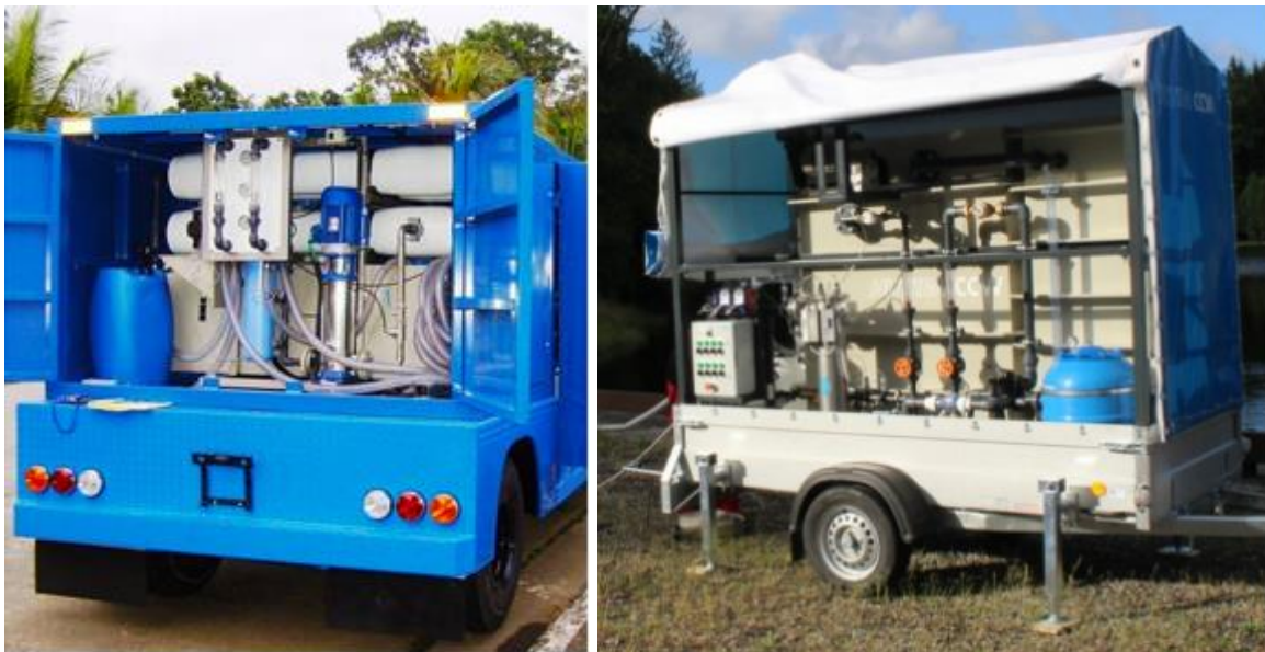
Obrázek 4-17 - Příklady menších mobilních úpraven vody [50][52]
