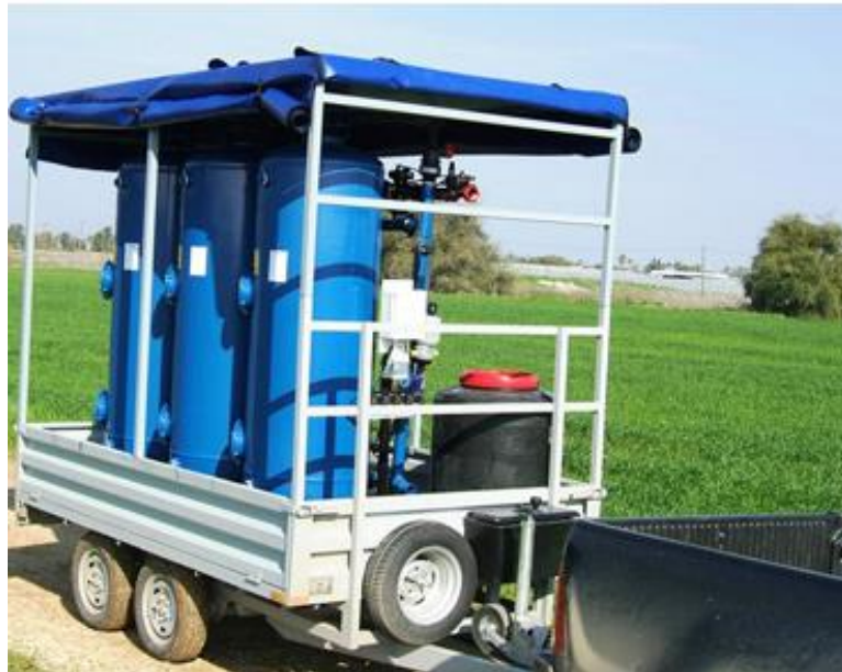
Obrázek 4-19 - Kompaktní mobilní automatická jednotka pro úpravu vody[52]
