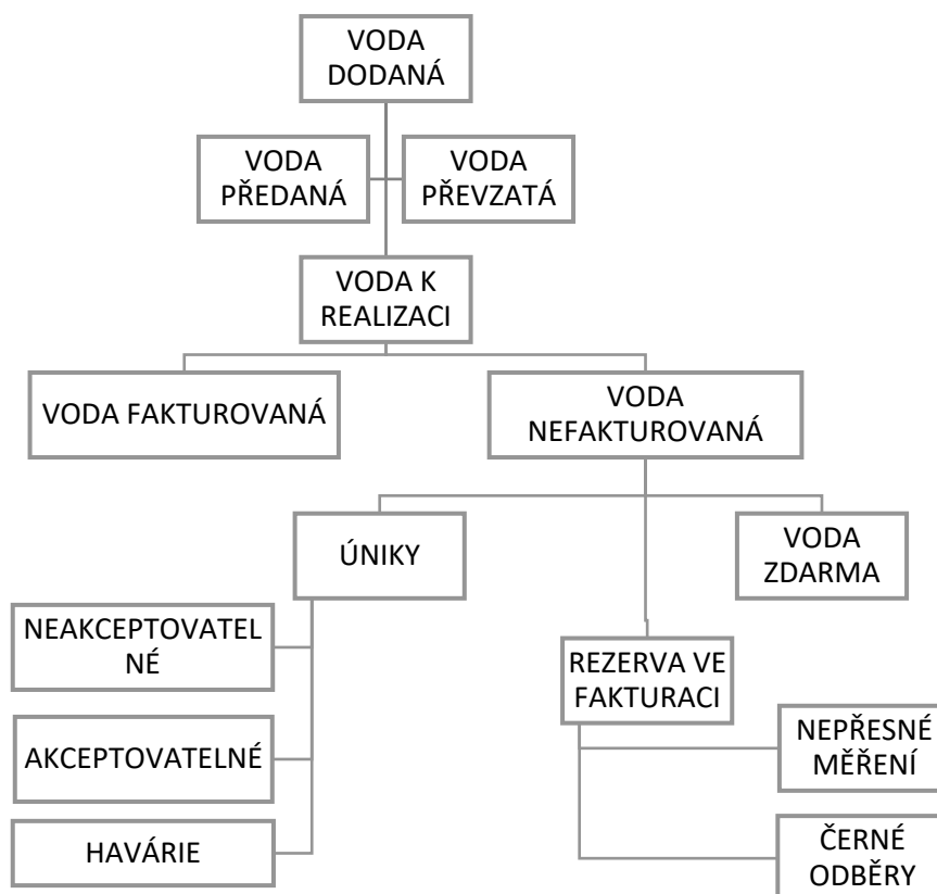
Obrázek 4-1 - Schéma složek vody dodané [24]
