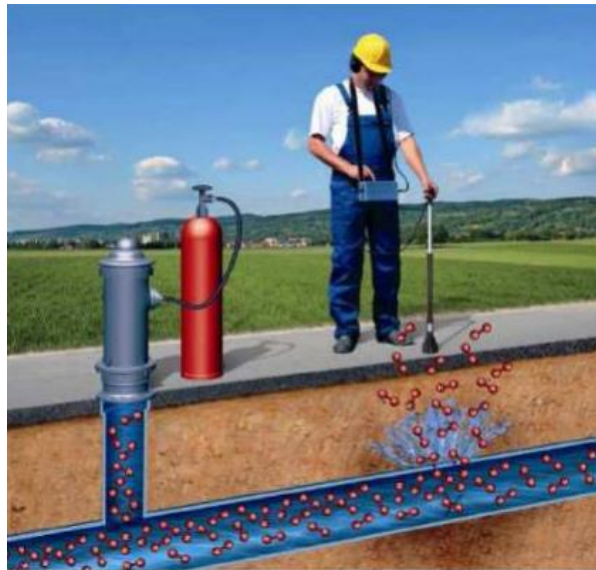
Obrázek 4-3 - Schéma detekce trasovacího plynu [34]
