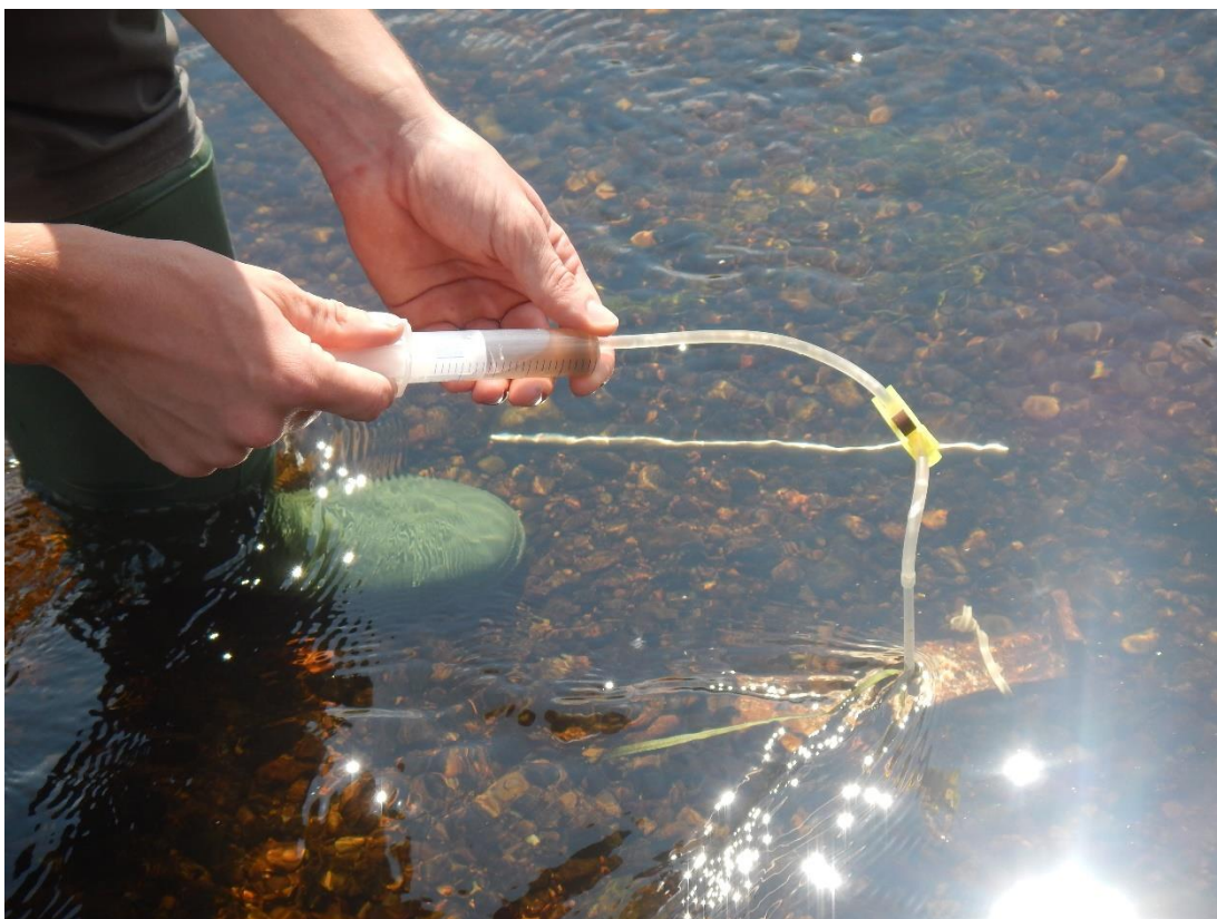
Příloha 3 Odběr vzorku hyporeálové vody za využití stříkačky, flexibilní hadičky a PVC trubičky, foto: O. Simon.
