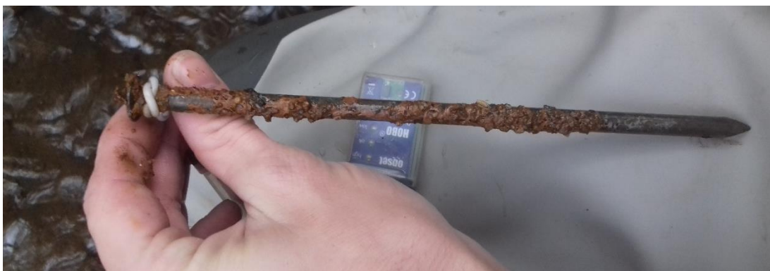
Příloha 5 Příklad kotvícího hřebíku z velké části pokrytého rží, vlastní fotografie.
