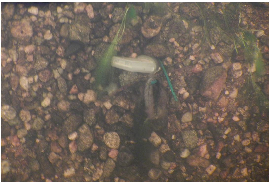
Příloha 4 Příklad jedné sady teploměrů umístěné ve dně, vlastní fotografie.
