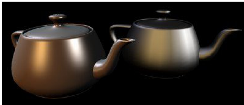
Obrázok 5.5: Porovnanie: Phong shading (vľavo) a Gouraud shading(vpravo)
