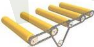
Obr.04 Pohon řetězovými smyčkami [7]
