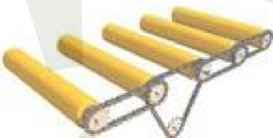
Obr.04 Pohon řetězovými smyčkami [7]
