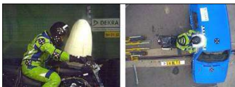
Obr. 46: Nárazová zkouška motocyklu Yamaha FZS 600 do vozidla VW Golf II [46]
