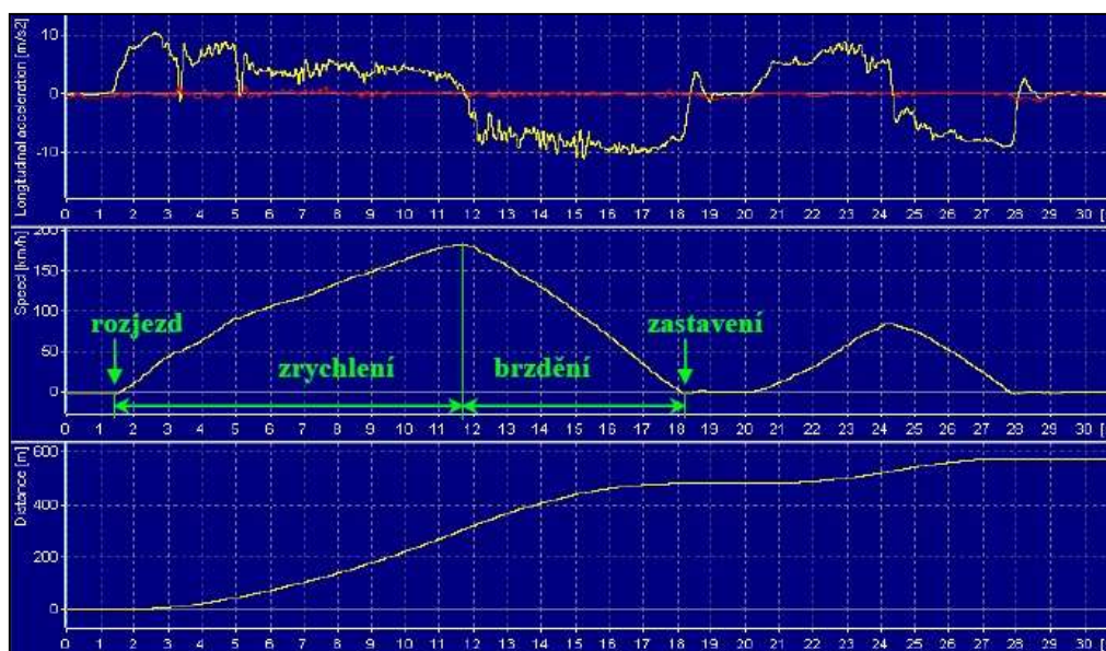
Graf 24: Průběh měření na motocyklu Yamaha YZF R6 (vodorovná osa – čas [s], svislá osa shora – zrychlení [ \text{m}\cdot\text{s}^{-2} ], rychlost [ \text{m}\cdot\text{s}^{-1} ], dráha [m])
