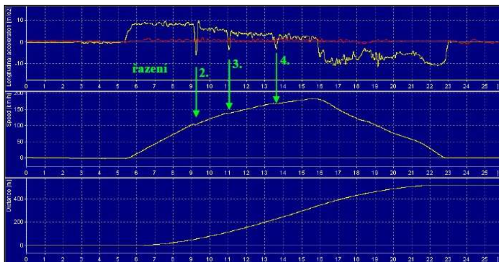
Graf 25: Průběh měření na motocyklu Kawasaki Z1000 (vodorovná osa – čas [s], svislá osa shora – zrychlení [m.s -2 ], rychlost [m/s], dráha [m])
