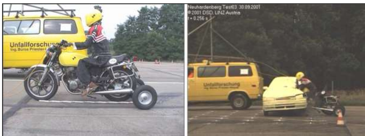
Obr. 9: Motocykl Yamaha XS400 (vlevo), pohyb dummy figuríny přes řídítka a kapotu vozidla (vpravo) [92]
