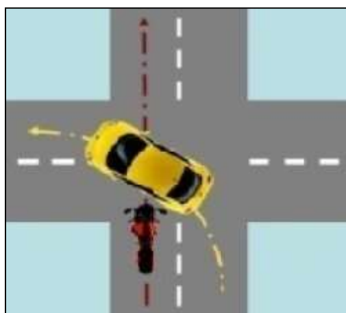
Obr. 89: Střet předjíždějícího motocyklu s vozidlem, které odbočuje vlevo (vozidlo jede stejným směrem)
