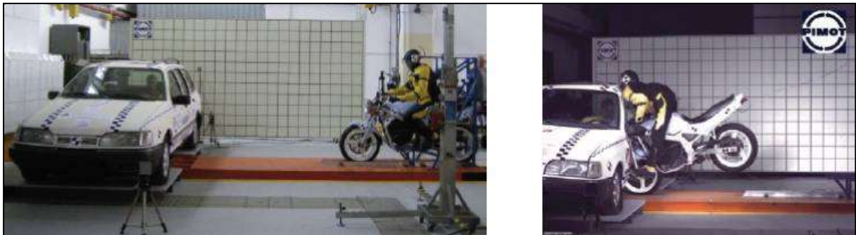
Obr. 29: Průběh crash testu před kolizí (vlevo) a v čase 100 ms (vpravo) [66]
