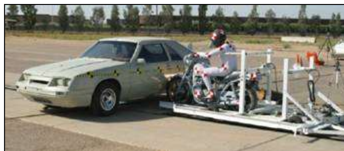
Obr. 24: Crash test jedoucího motocyklu do jedoucího vozidla [62]
