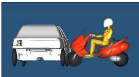
Obr. 15: Simulace bočního nárazu motocyklu do vozidla [44]
