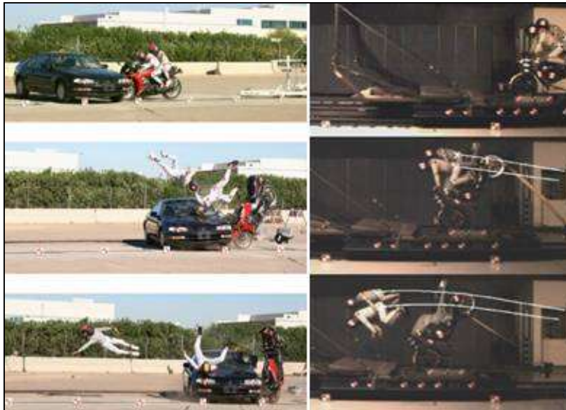
Obr. 20: Postřetový pohyb motocyklisty a jeho spolujezdce po nárazu do vozidla. Pohyb motocyklisty a jeho spolujezdce po aplikaci přední brzdy (580, 812 a 984 ms) [63]
