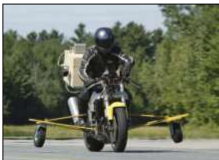
Obr. 35: Měření brzdného zpomalení motocyklů [22]
