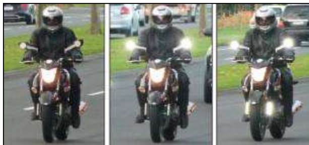
Obr. 65: Různé konfigurace osvětlení motocyklu [76]
