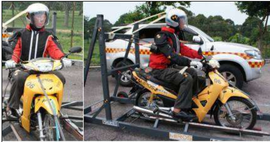
Obr. 31: Dummy figurína na motocyklu a roztahovací systém [72]
