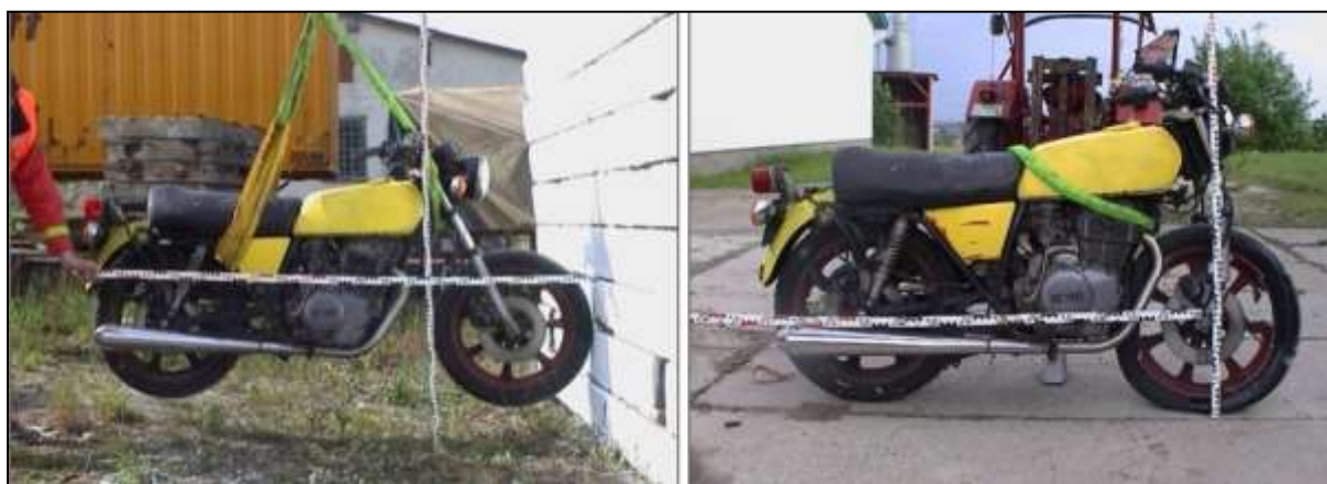
Obr. 11: Střetová poloha (vlevo), zkrácení rozvoru a celkové zkrácení délky (vpravo) [93]
