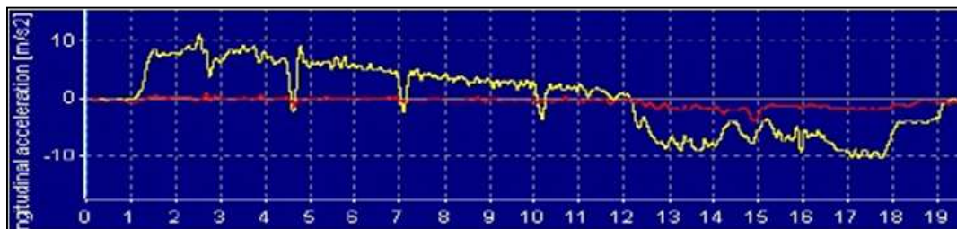
Graf 26: Průběh zrychlení motocyklu Honda CB 600 Hornet (vodorovná osa – čas [s], svislá osa – zrychlení [m.s -2 ])
