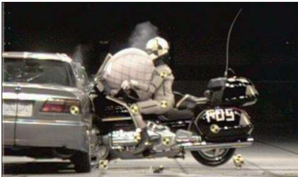
Obr. 43: Aktivovaný airbag na motocyklu Honda Goldwing při střetu s vozidlem [94]
