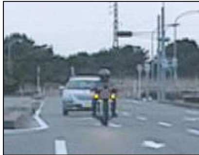
Obr. 62: Zvýšení viditelnosti pomocí dvou žlutých světel [79]
