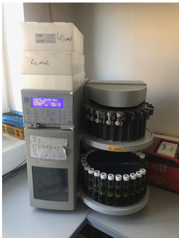
Obrázek 4 Přístroj pro extrakci za zvýšeného tlaku a teploty ASE (Foto: Mgr. Alena Grasserová)
