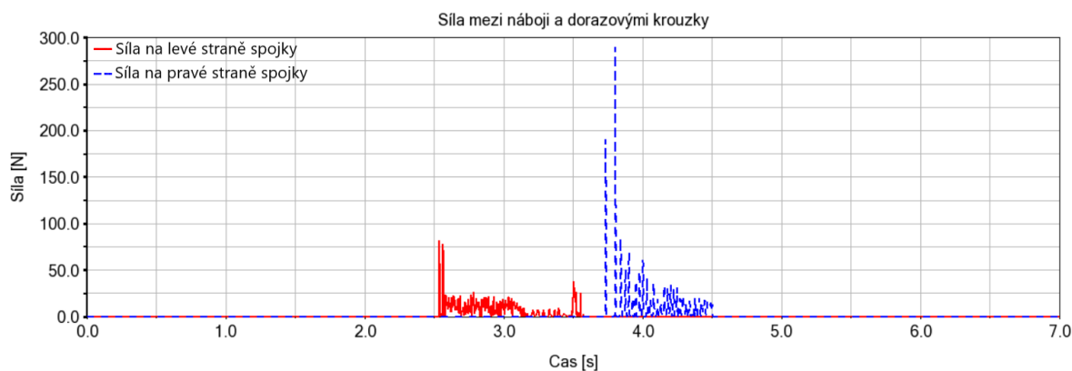
Obr. 8.14 Graf síly působící při nárazu na dorazové kroužky
