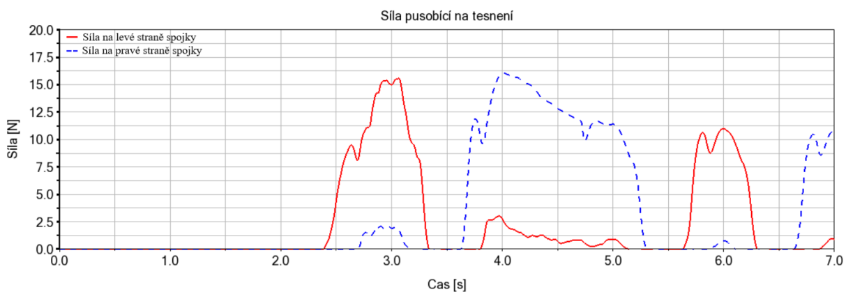
Obr. 8.15 Graf síly působící mezi těsněním a víkem
