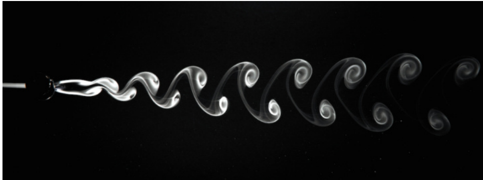
Obr. 1.8: Kármánová vírová cesta pri obtekaní válca. Prevzaté z [19].
