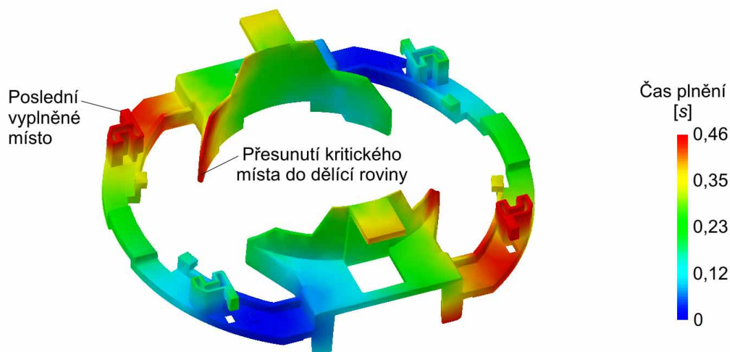
Obr. 8.20 Čas plnění - po posunutí vtoků
