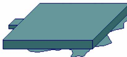
Obr. 4.17 Průnik taveniny do dělicí roviny [27]
