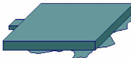
Obr. 4.17 Průnik taveniny do dělící roviny [27]
