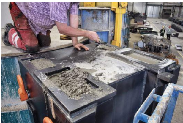
obr. 1 Betonová konstrukce obráběcího centra [2]
