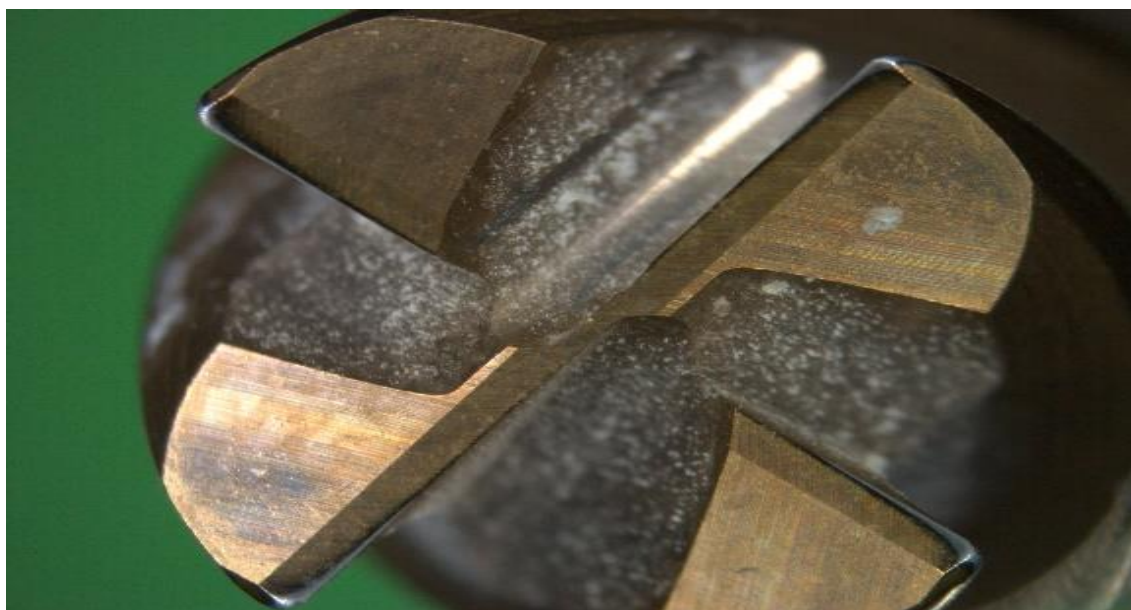
obr. 38 Opotřebení čela, vzorek 5.(foto autor)
