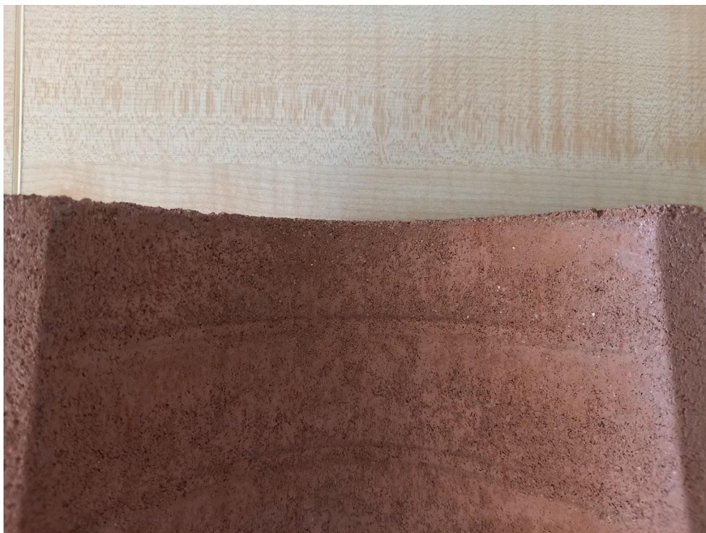
obr. 55 Stav po apretaci trajektorie 2, zadní část - apretace nástrojem kolmo k hraně
