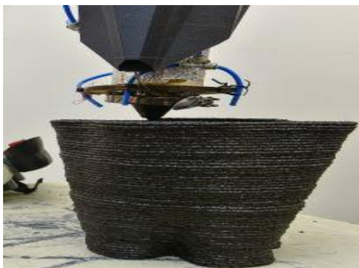
obr. 2 tisková hlava pro tisk polymerního betonu [3]
