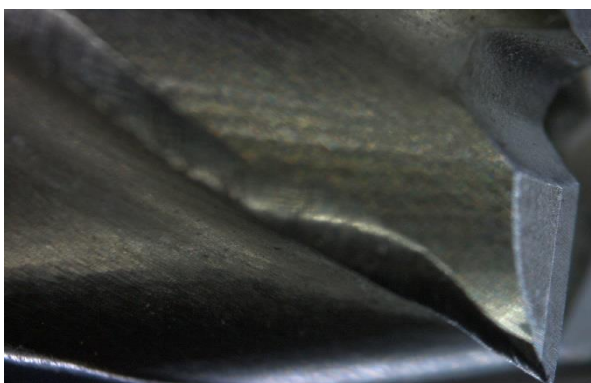
obr. 28 Opotřebení břitu (foto autor)
