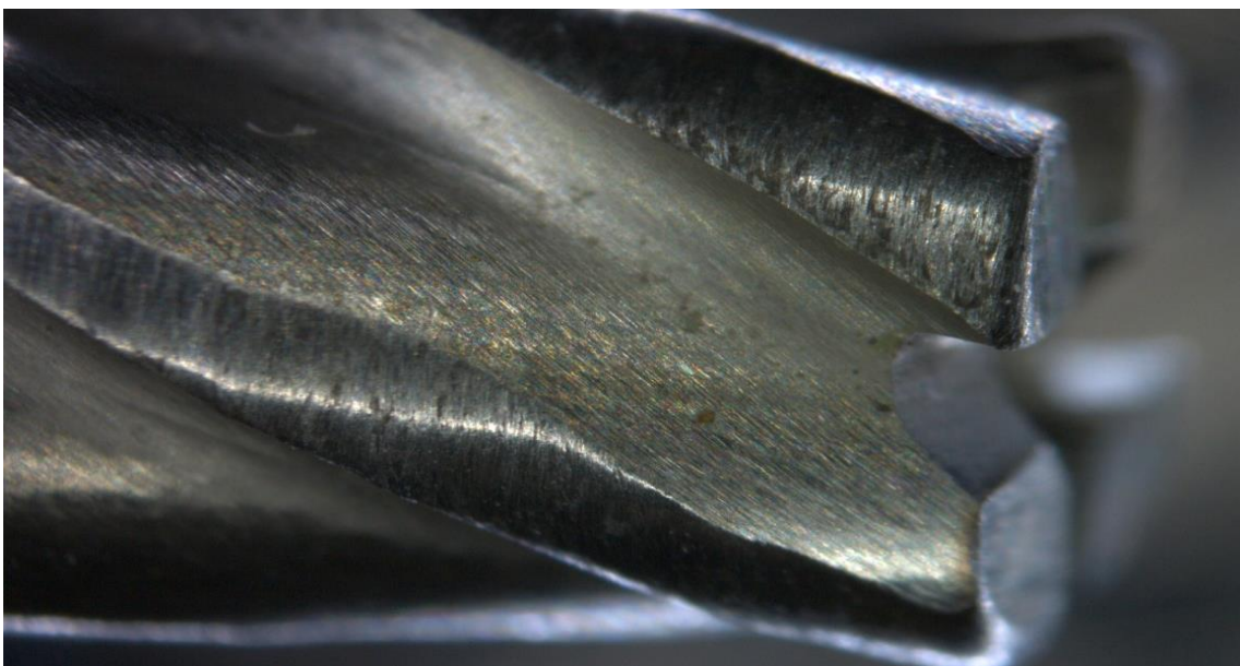
obr. 32 Opotřebení vzorku 1. (foto autor)
