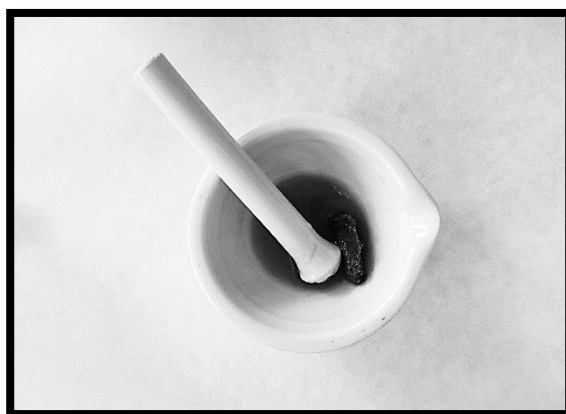
Obr. 3. Navážené množství se přeneslo do porcelánové misky s 15 ml bentonitu a bylo homogenizováno pomocí porcelánového tloučku.
