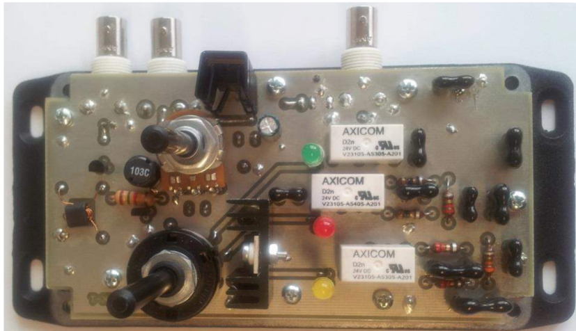
Obr. 71 Foto zesilovače bez krytu
