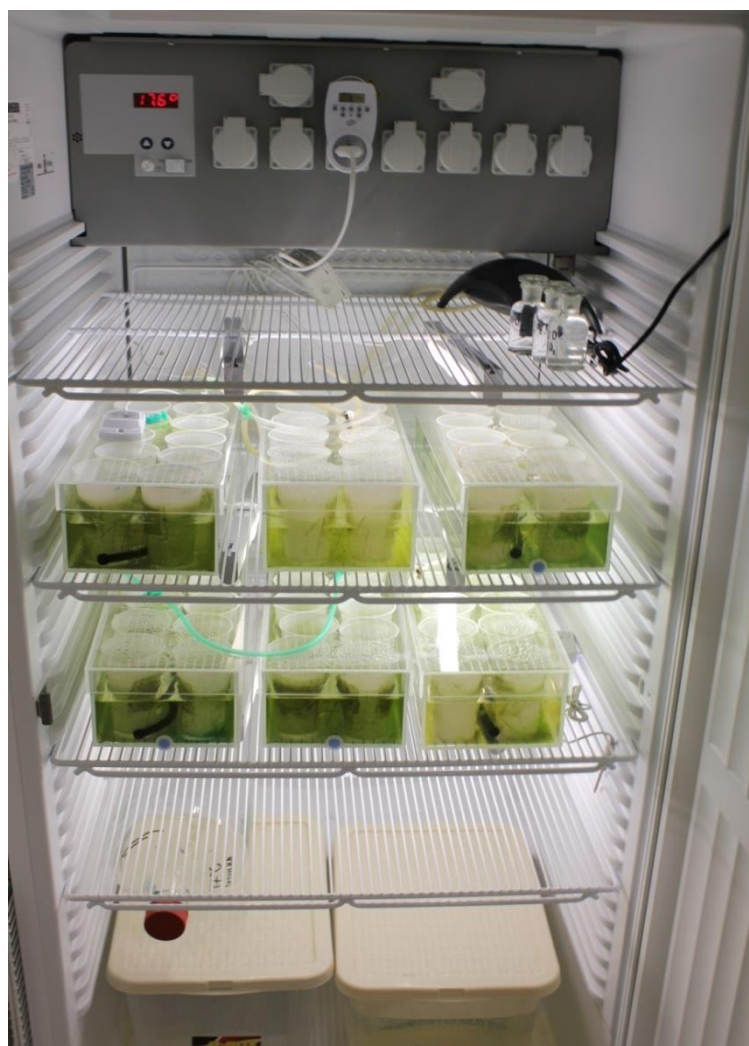
Příloha Obr. 4: Termostat s 6 boxy a 12 označenými kelímký s individuálními kódy s larvami v 24°C.
