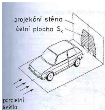
Obrázek 10- Zjištění čelní plochy vozidla projekcí
