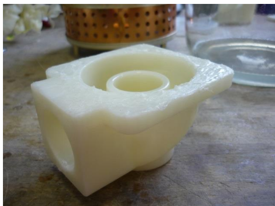
Obr. 6.50 Model poškodený naleptaním.
