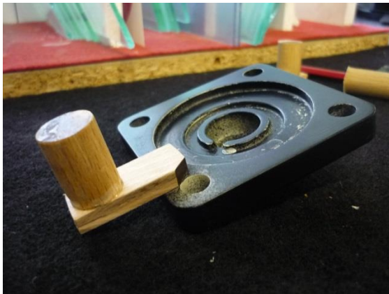
Obr. 6.62 Napojenie drevenej vtokovej sústavy.
