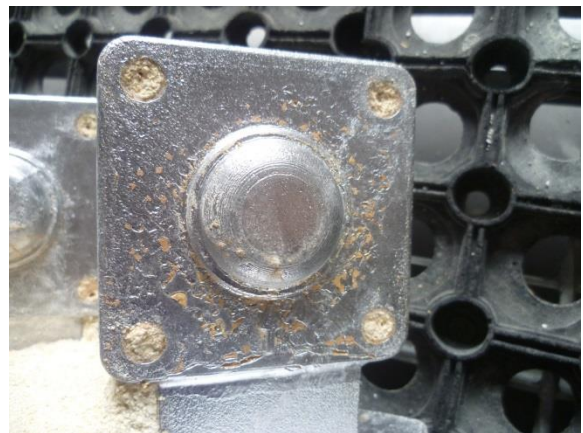
Obr. 8.2 Defekt odliatku z tmeleného modelu.
