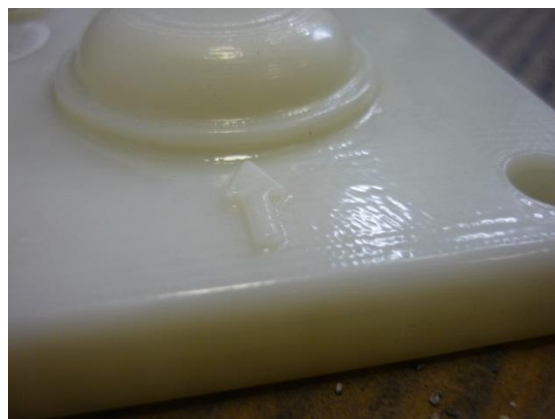
Obr. 6.53 Detail naleptaného povrchu veka.
