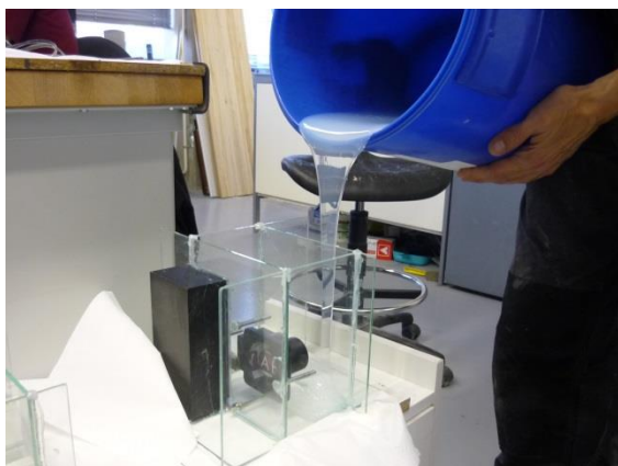
Obr. 6.70 Plnenie formy silikónom.
