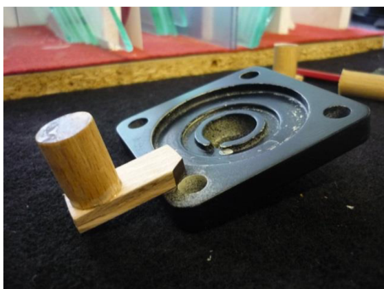
Obr. 6.62 Napojenie drevenej vtokovej sústavy.
