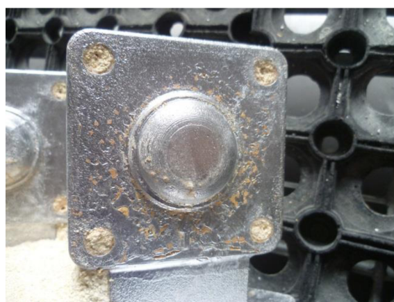
Obr. 8.2 Defekt odliatku z tmeleného modelu.
