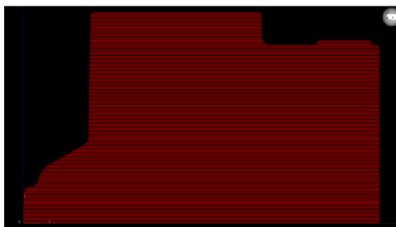
Obr. 6.33 Rozdelenie ventilu na vrstvy.
