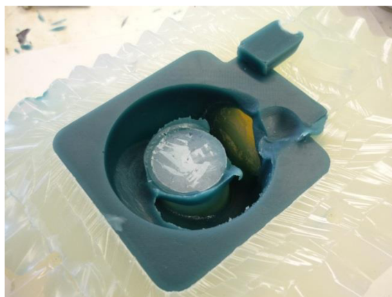
Obr. 6.83 Zničený voskový model ventilu.
