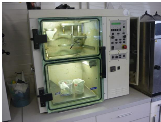
Obr. 6.60 Odstraňovanie tekutiny vo vákuu.
