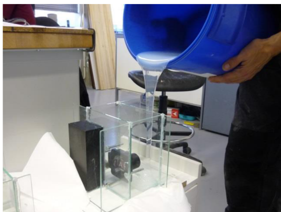
Obr. 6.70 Plnenie formy silikónom.
