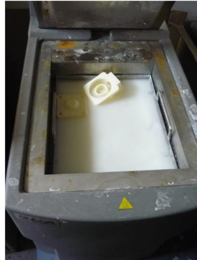
Obr. 6.39 Modely v ultrazvukovej čističke.
