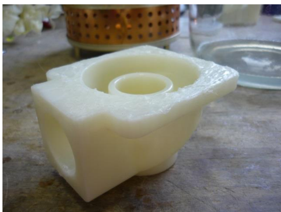
Obr. 6.50 Model poškodený naleptaním.
