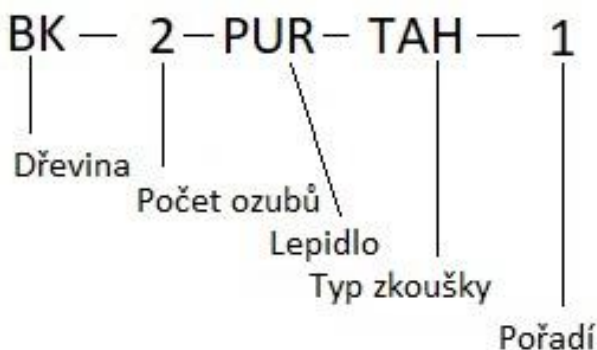
Obrázek 43: Postup značení vzorků, zdroj: vlastní
