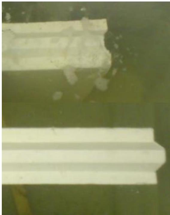
Obr. č. 16 : Tvárnice bez hydrofobního nátěru a s nátěrem při zkoušce nasákavosti
