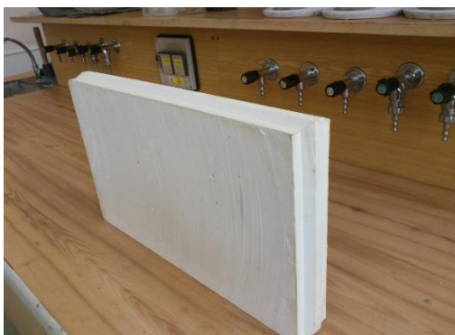
Obr. 13: Sádrová tvárnice po odformování
