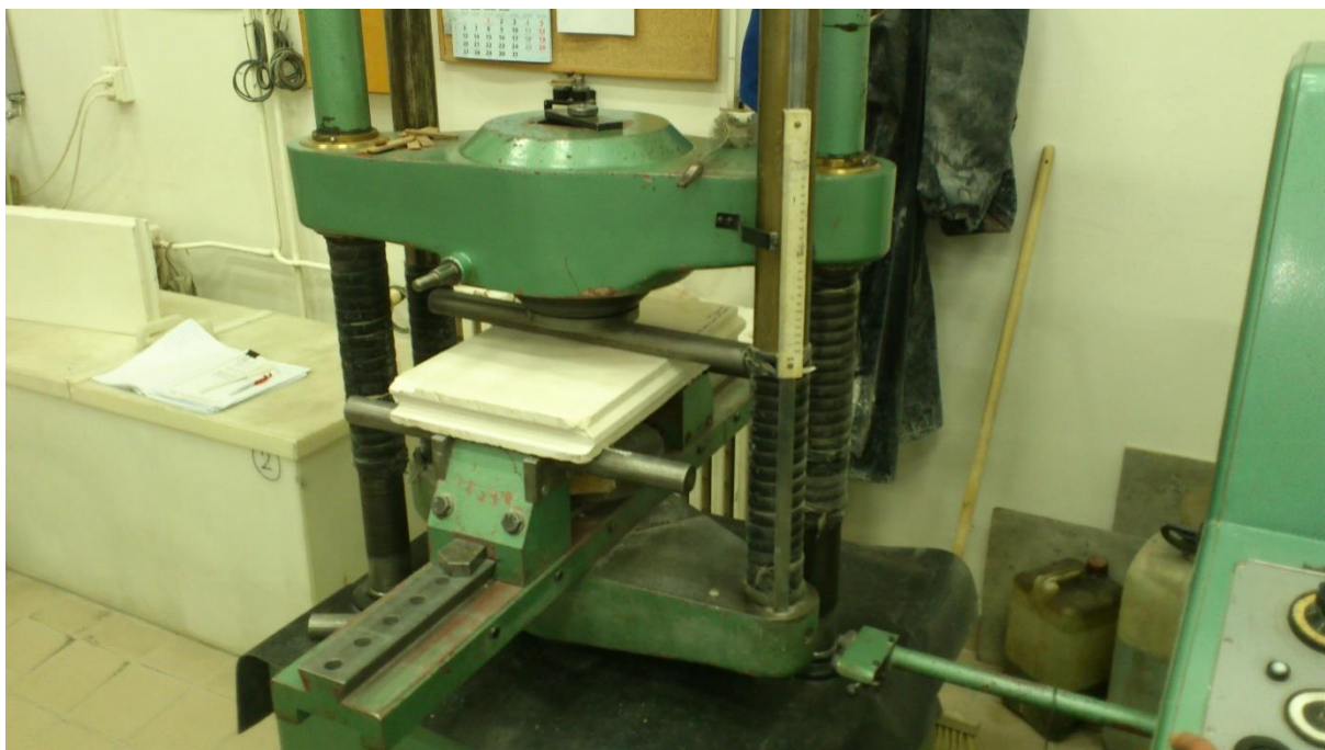
Obr. č. 15: Tvárnice při zkoušce pevnosti v tahu za ohybu
