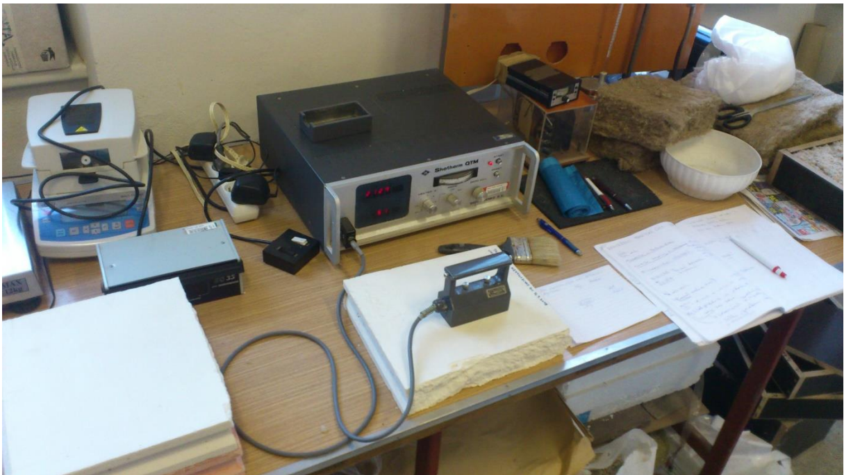
Obr. č. 17 : Měření součinitele tepelné vodivosti metodou horkého drátu
