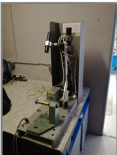
Obr. 13 Kolimátor pro justáž vertikální roviny
