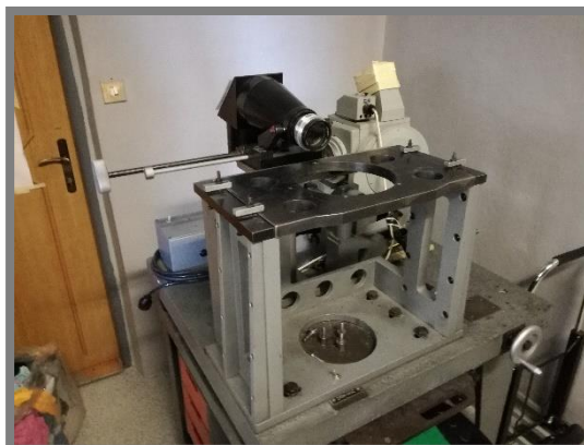
Obr. 12 Kolimátor pro justáž přenosu úhlů
