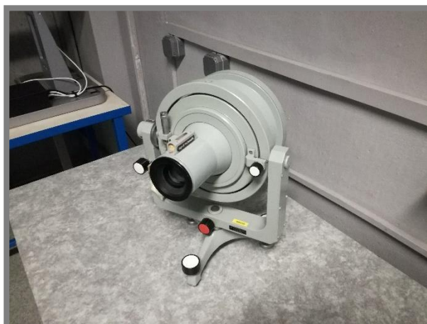
Obr. 14 Kolimátor pro justáž zorného pole
