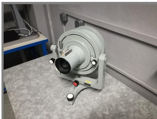
Obr. 14 Kolimátor pro justáž zorného pole
