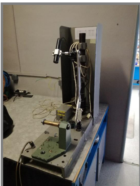
Obr. 13 Kolimátor pro justáž vertikální roviny
