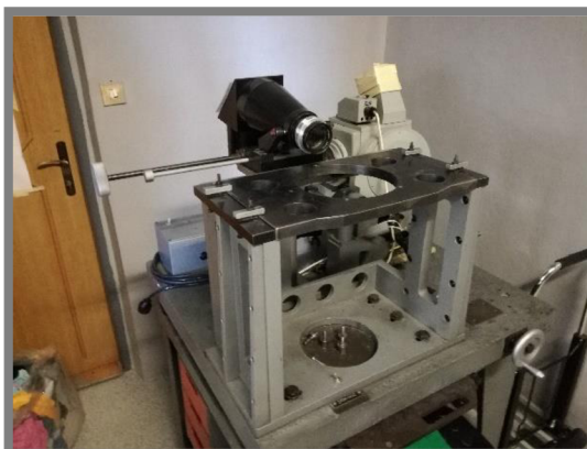
Obr. 12 Kolimátor pro justáž přenosu úhlů
