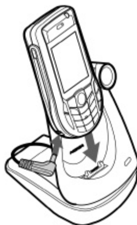
Obr. 9.9: Zapojení videotelefonního modulu PT-8
