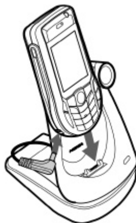
Obr. 8.8: Zapojení videotelefonního modulu PT-8
