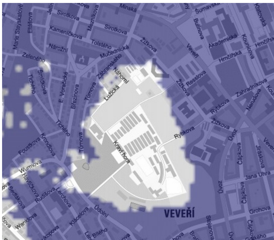
Obr. 4.1: Oblast pokrytí signálem UMTS nejčastěji prováděné analýzy (Kraví hora - Brno). Tmavá barva značí výborné pokrytí signálem [22].
