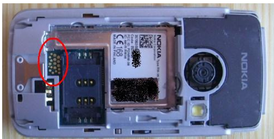
Obr. 5.5: Servisní konektor mobilního terminálu Nokia 6680
