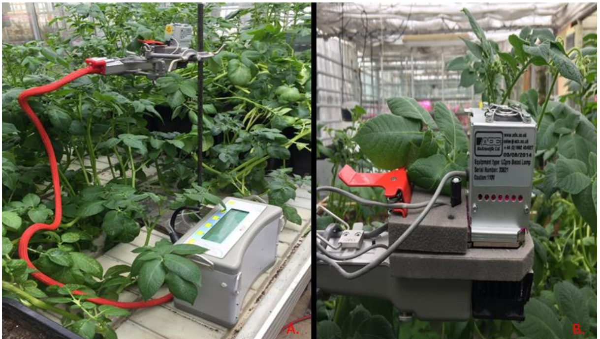
Obrázek 15 – A. Měření výměny plynů za využití LCpro+, B. Detail měřicí komory LCpro+ (Autor)
