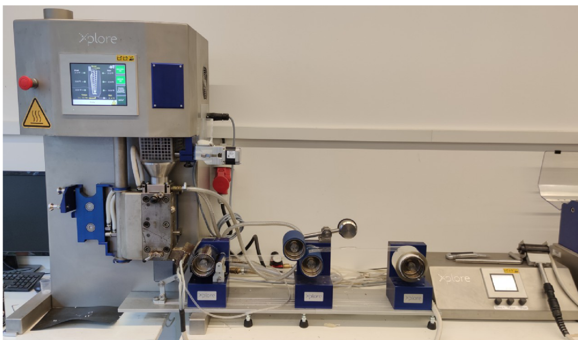
Obr. 3.1 Mikrokompaundér Xplore MC 15 HT s přídatným zařízením CFL 50 při výrobě fólie
