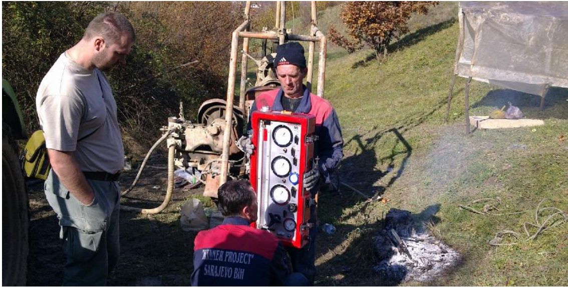
Obr. 2.23: GTP pro projekt obchvatu Zenice, BiH, realizace presiometrické zkoušky v trase budoucího tunelu,
