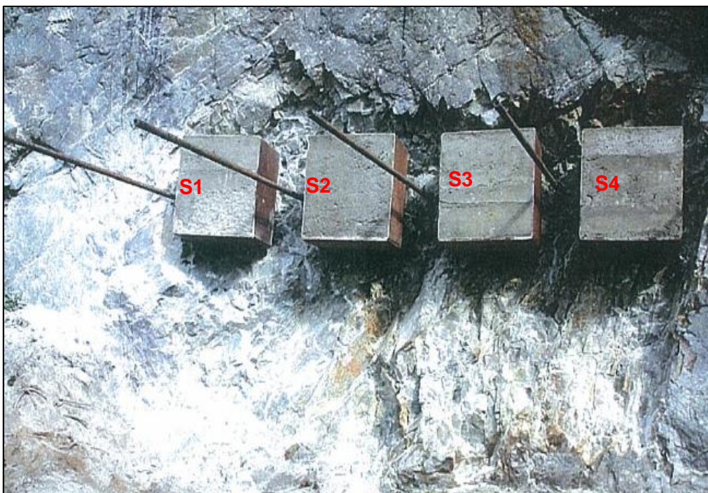
Obr. 6.7: VMO Žabovřeská Brno, bloky smykových zkoušek ve stěně bývalého lomu, jižní portál [18]
