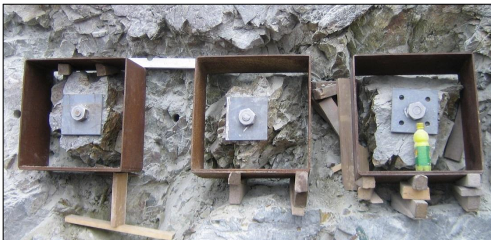
Obr. 2.24: VMO Žabovřeská Brno, příprava zkušebních bloků pro smykovou zkoušku [18]
