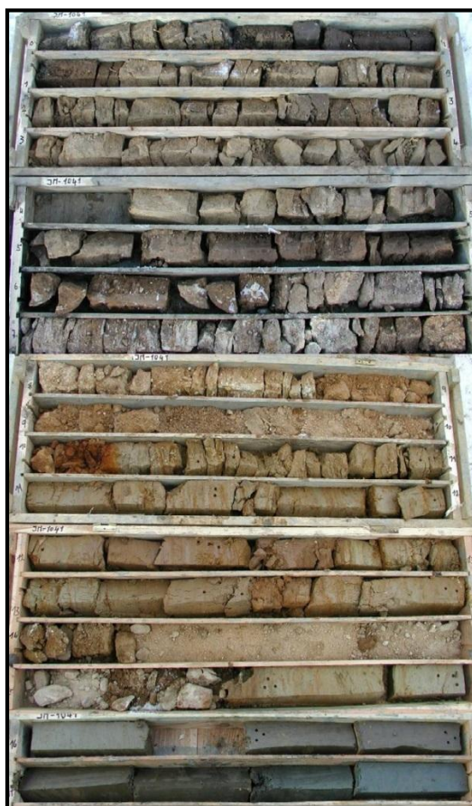
Obr. 2.6: GTP pro Královopolské tunely v Brně, ukázka vrtného jádra, vrt JM 1041 [17]
