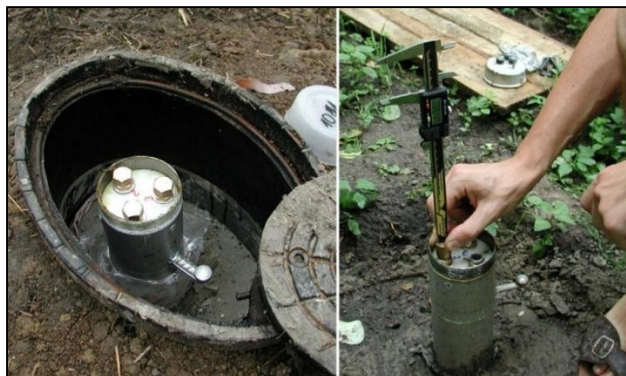
Obr. 6.33: Zhlaví extenzometru a ukázka měření [17]
